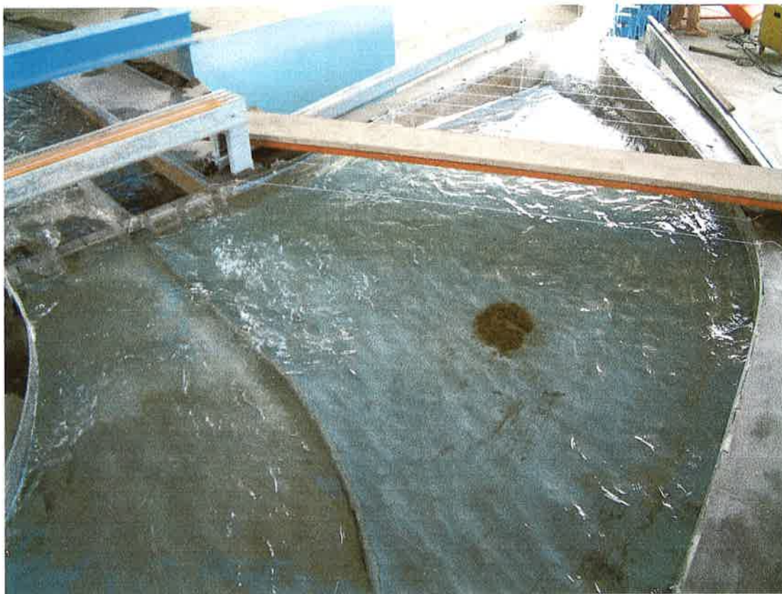
照片 6-2 基隆河員山子分洪水工模型試驗於 Q_5=837 \text{ cms} 之側流堰流況
