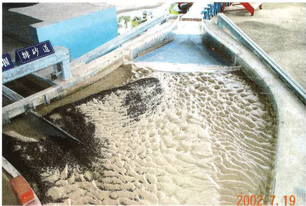
照片 7-12：建議案試驗、分洪堰上游淤積情形
