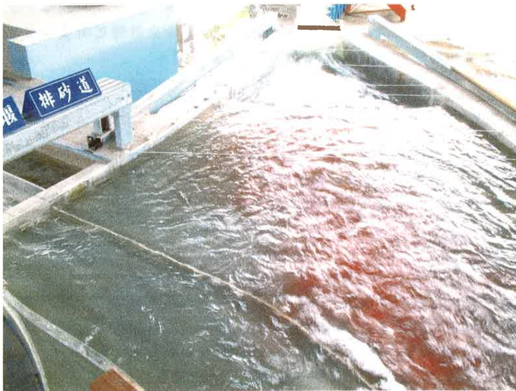
照片 7-5：建議案 Q_{200}=1620\text{cms} 攔河堰上游及進水結構之流況
