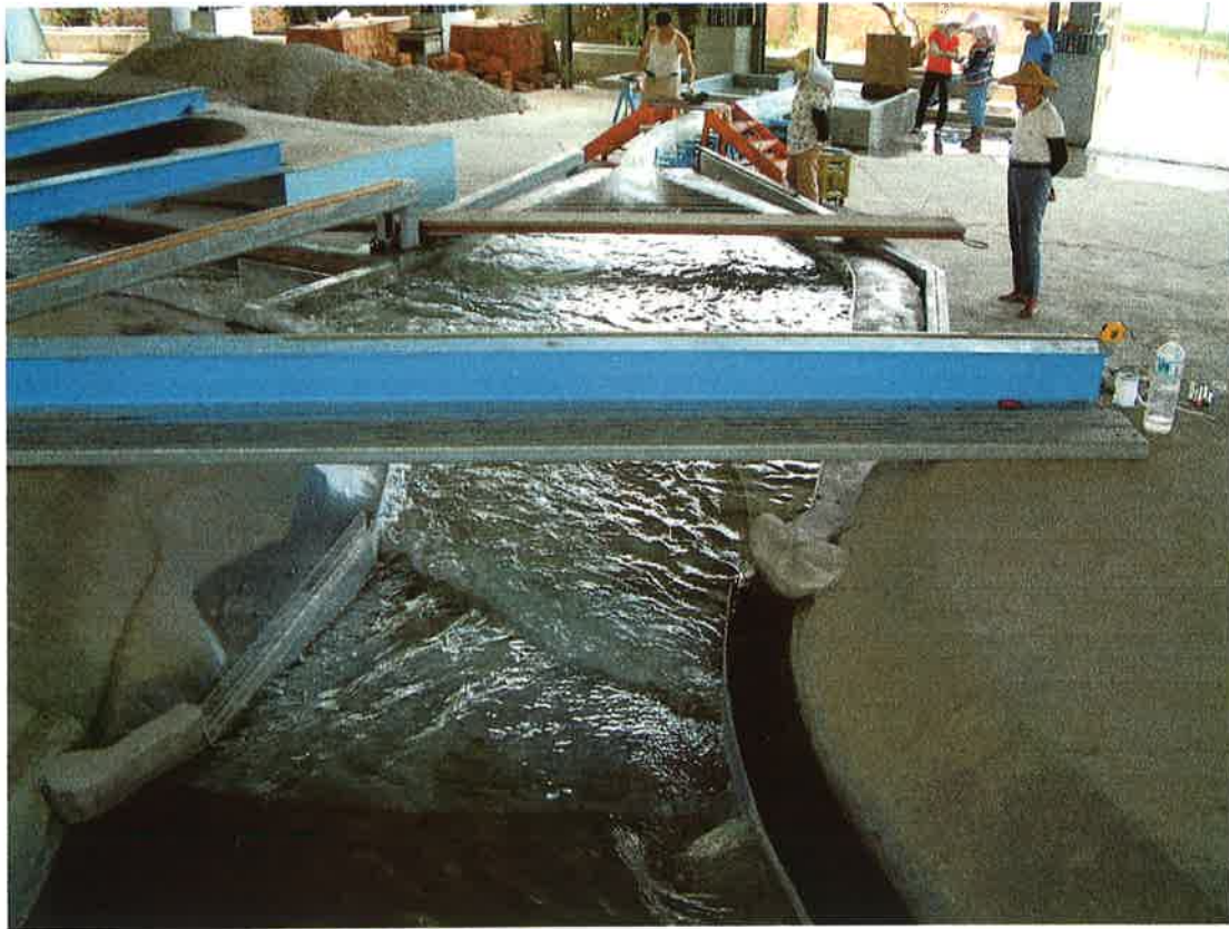
照片 6-1 基隆河員山子分洪水工模型試驗於 Q_5=837 \text{ cms} 之上游流況
