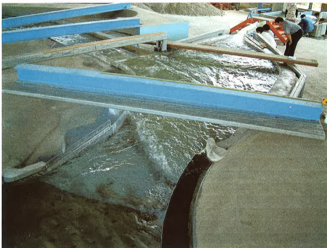
照片 6-4 基隆河員山子分洪水工模型試驗於 Q_{200}=1620 \text{ cms} 之上游流況
