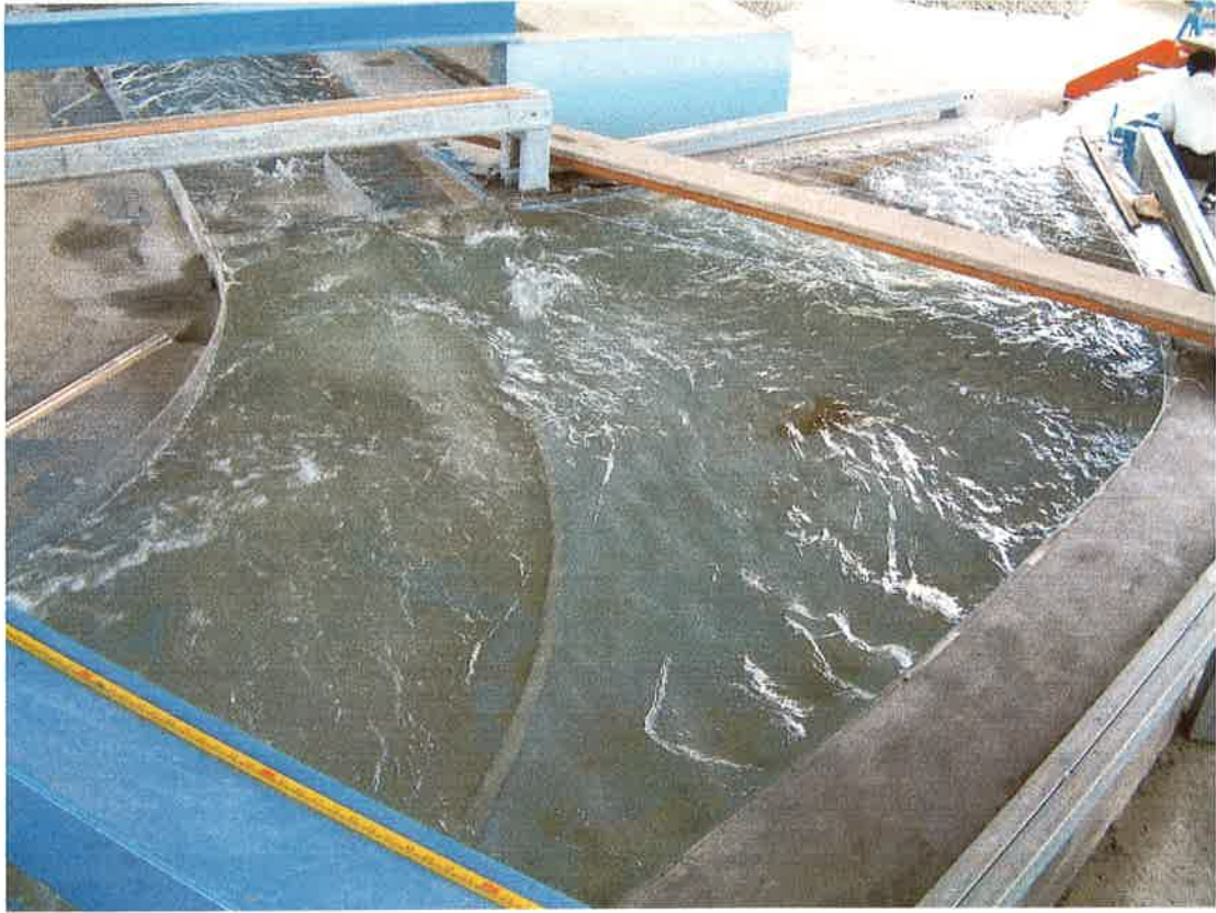
照片 6-5 基隆河員山子分洪水工模型試驗於 Q_{200}=1620 \text{ cms} 之側流堰流況
