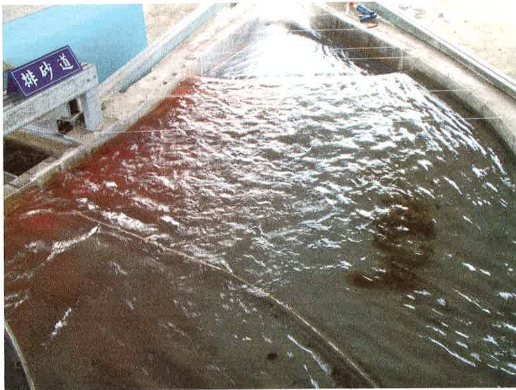
照片 7-1：修改案 Q_5=837\text{cms} 攔河堰上游及進水結構之流況
