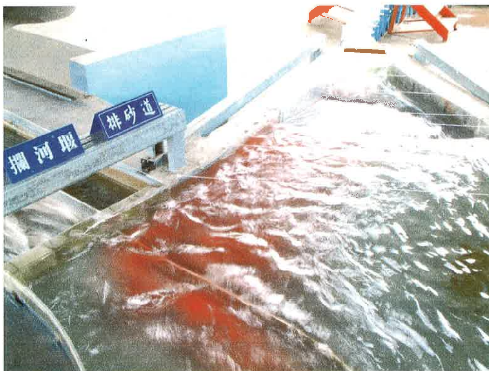
照片 7-3：修改案 Q_{200}=1620\text{cms} 攔河堰上游及進水結構之流況
