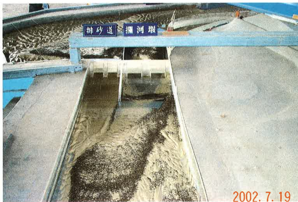
照片 7-14：建議案試驗、攔河堰下游淤積情形
