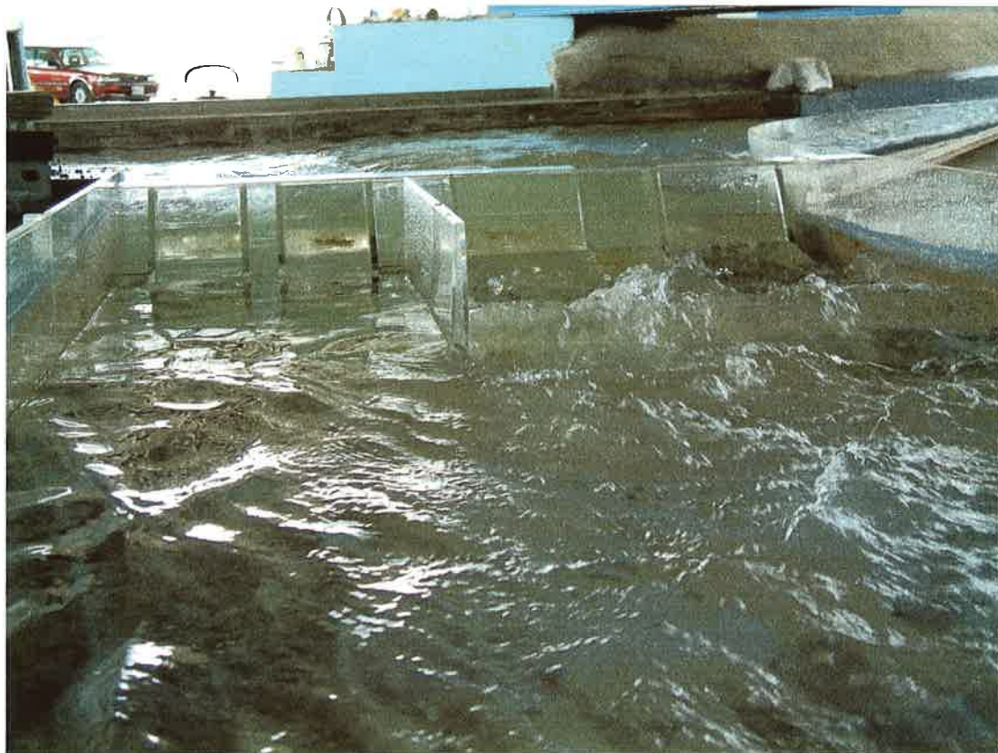
照片 6-3 基隆河員山子分洪水工模型試驗於 Q_5=837 \text{ cms} 之攔河堰下游流況
