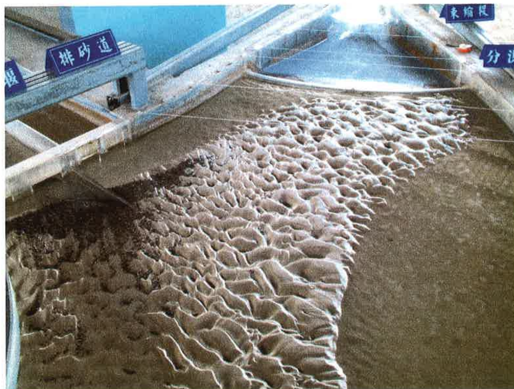
照片 7-8：修改案試驗、分洪堰上游淤積情形
