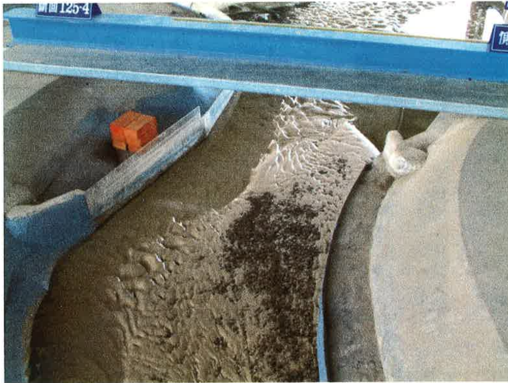
照片 7-7：修改案試驗、彎道（斷面 125-4）凸岸淤積情形
