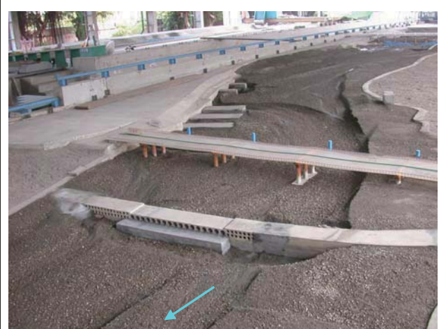
12.試驗後地形（后豐橋下游臨時便道處）
