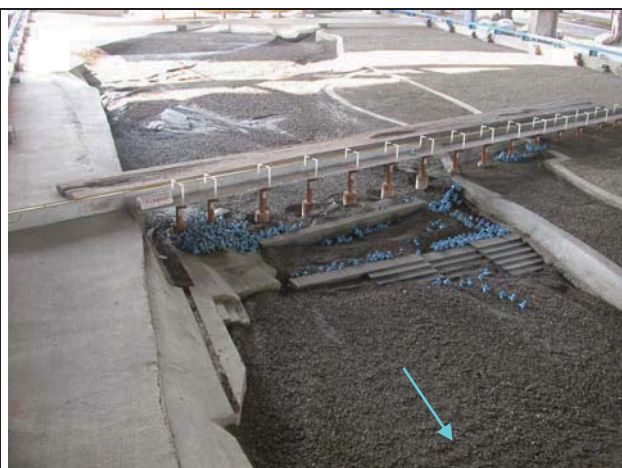
8.試驗後地形（新山線鐵路橋下游）
