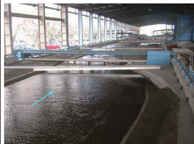
9.漲水段 1,959 秒立方公尺（后豐橋上游）
