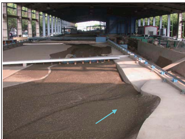
7.試驗後地形（新山線鐵路橋上游）
