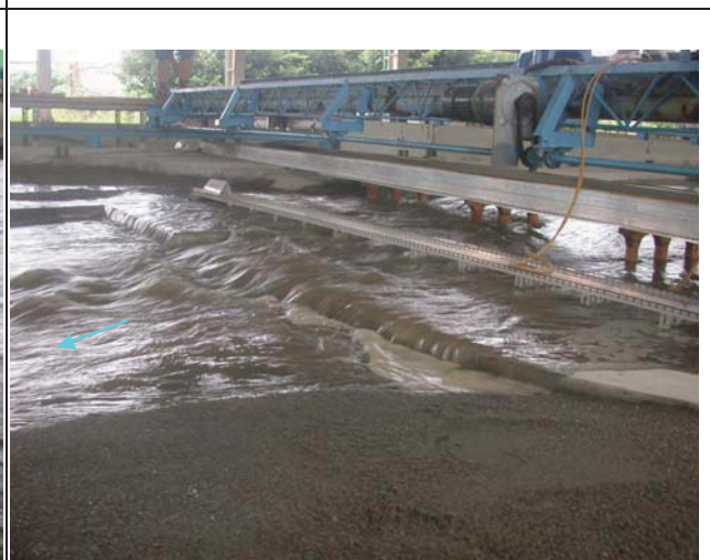
6. 試驗洪峰流量 3,955 秒立方公尺通過后豐橋流況
