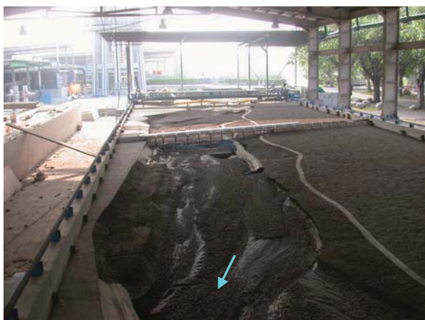
9.試驗後地形（新山線鐵路橋下游）
