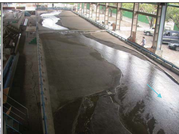
2. 試驗漲水段 2,480 秒立方公尺全斷面流況
