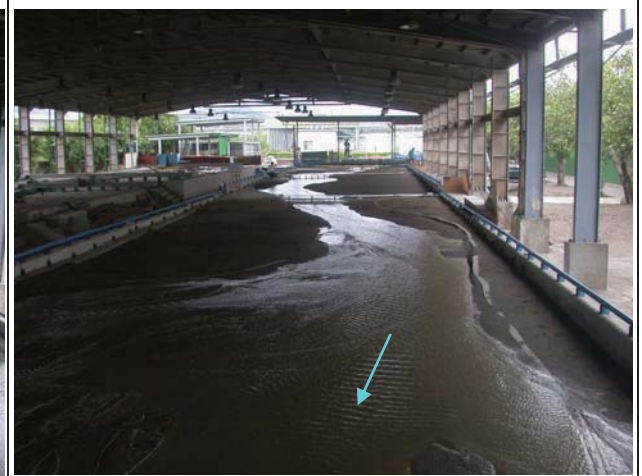
4.模型試驗 Q_2=2,200\text{cms} 流況
