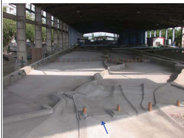
17.完成舊山線鐵路橋墩及地形塑造
