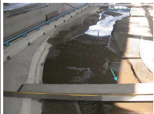
4.漲水段 266 秒立方公尺(后豐橋上游)
