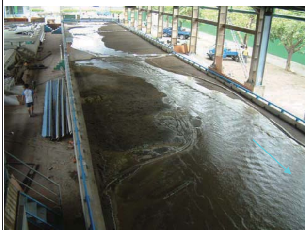
9. 模型試驗 Q_{100}=8,800\text{cms} 流況
