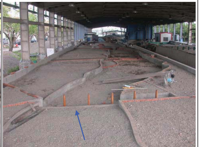
6.模型地形塑造過程（面向下游）
