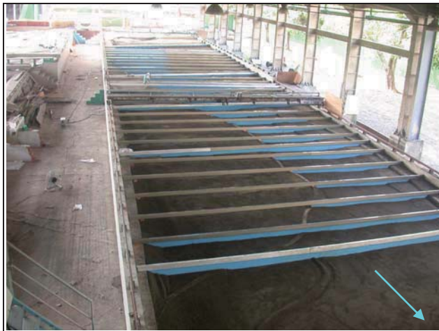
1.模型用陽板輔助鋪設地形
