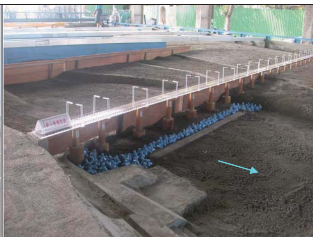
2. 試驗前新山線鐵路橋下游端布置消波塊
