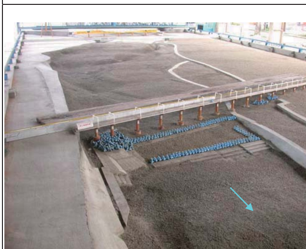
3.試驗前地形（新山線鐵路橋上下游）
