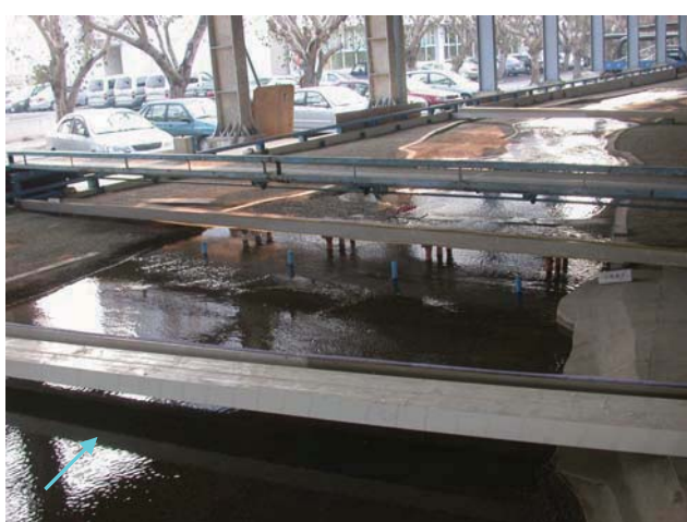
6. 漲水段 710 秒立方公尺 (后豐橋上下游)
