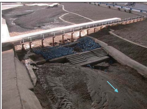
8 試驗後地形（新山線鐵路橋下游）
