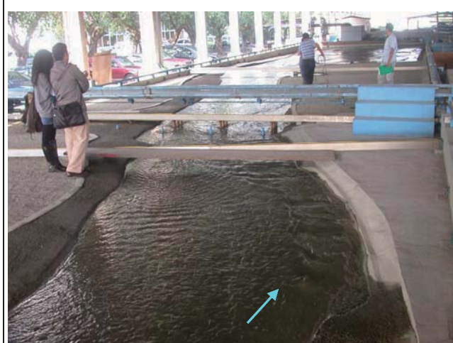
5.洪峰流量 4,007 秒立方公尺(后豐橋上下游)
