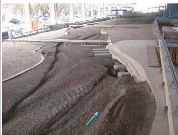
9.試驗後地形（后豐橋上游正隆護岸丁壩）
