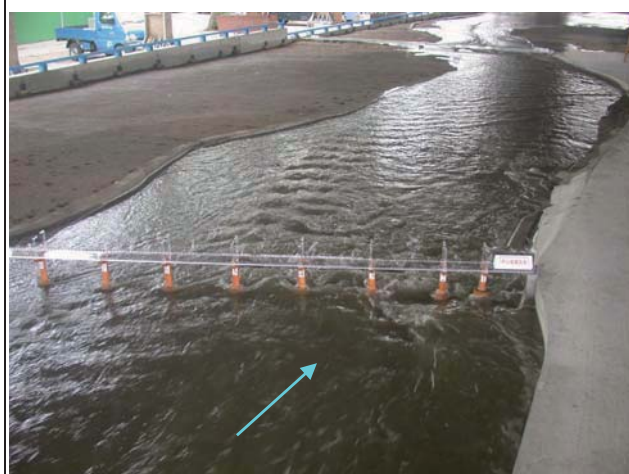
11. Q_{100}=8,800\text{cms} 通過新山線鐵路橋流況
