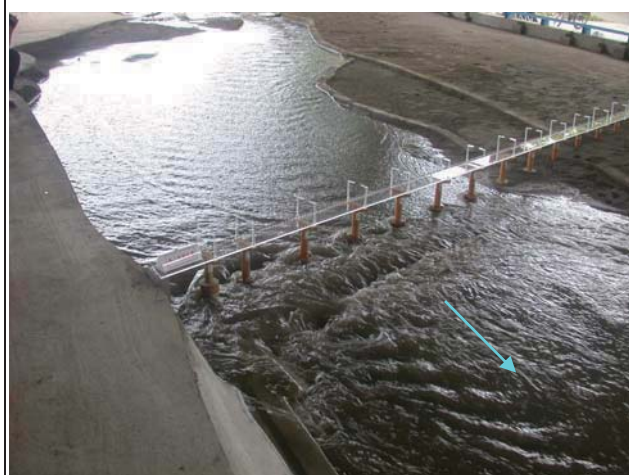
5. Q_5=3,800\text{cms} 通過新山線鐵路橋流況
