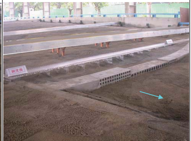
4. 后豐橋模型試驗前下游地形情況
