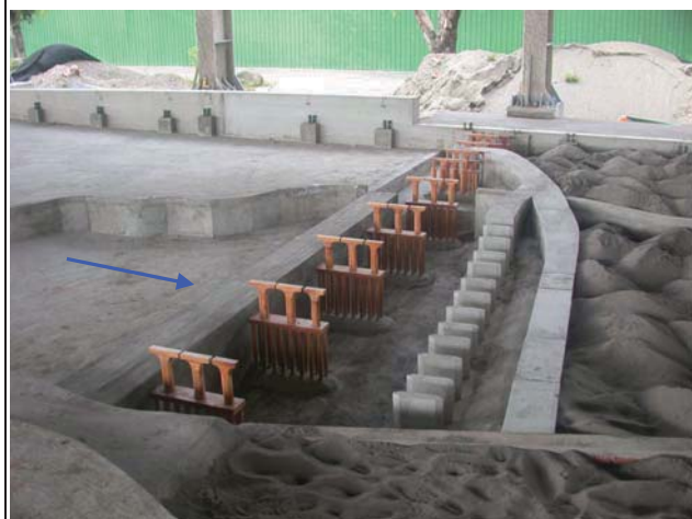
11.完成后豐橋橋墩及地形塑造（面向左岸）
