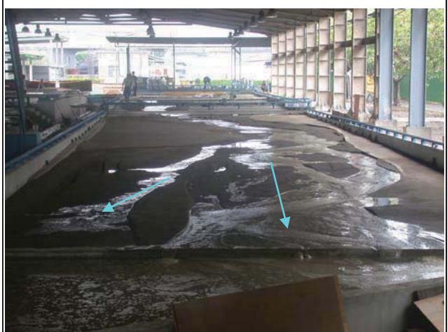
12.模型中山高速公路橋上游流路
