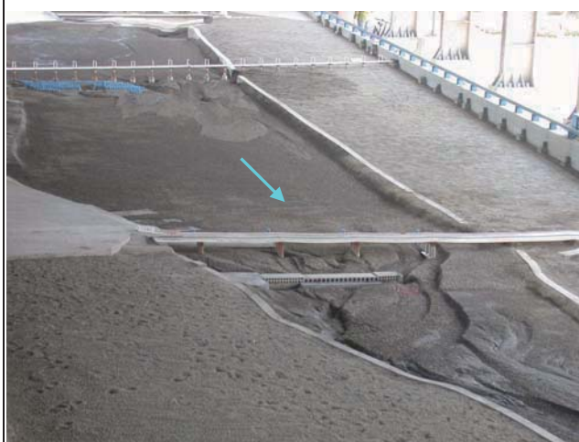
28.試驗後地形（新山線鐵路橋至后豐橋）
