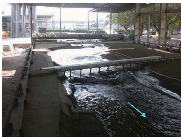
5.洪峰流量 4,007 秒立方公尺（新山線鐵路橋 上下游）
