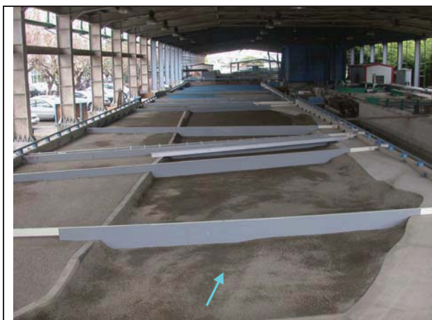
1. 零方案-5+護甲粒料補充及河槽左岸開挖 規劃構想試驗
