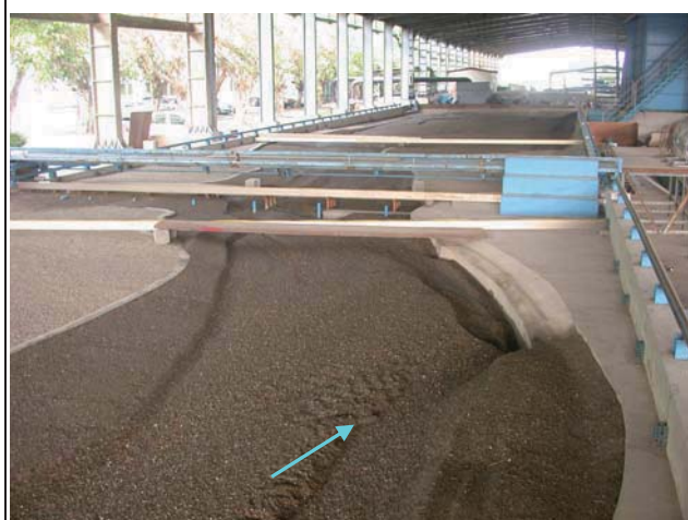
9.試驗後地形（后豐橋上下游）
