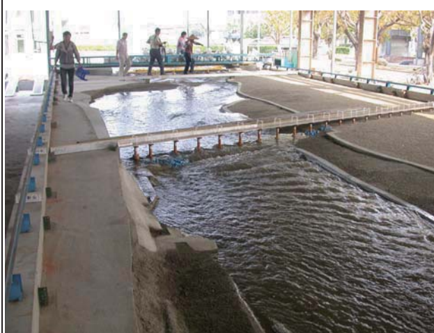
5.洪峰流量 4,525 秒立方公尺（新山線鐵路橋下游）
