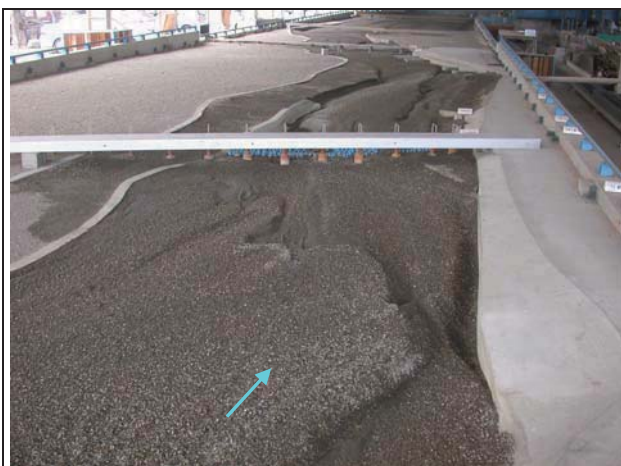
7.試驗後地形（新山線鐵路橋上游）
