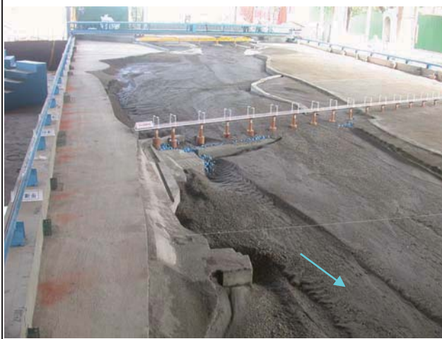
10. 試驗後新山線鐵路橋上下游情況
