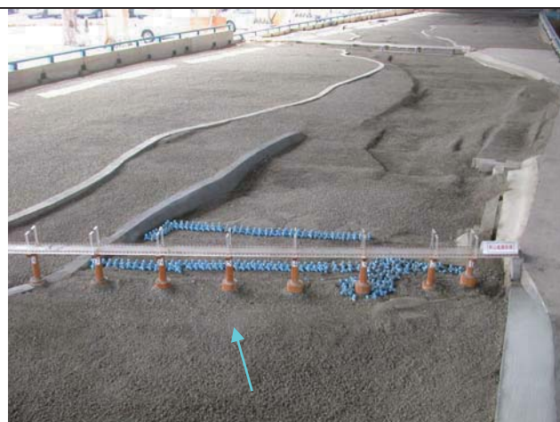
2.試驗前地形（新山線鐵路橋上游）
