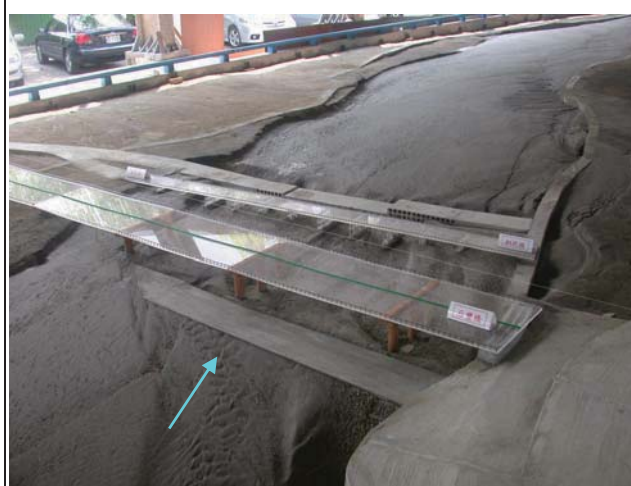
11. 試驗後后豐橋上下游情況
