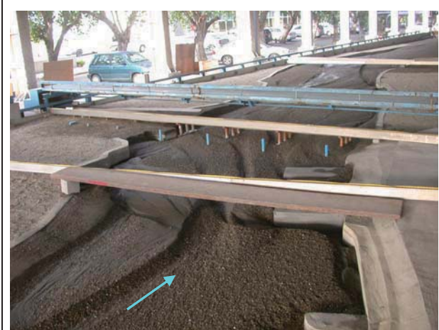
11.試驗後地形（后豐橋上游正隆護岸丁壩）
