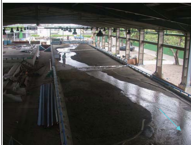
3.模型試驗 Q_2=2,200\text{cms} 流況
