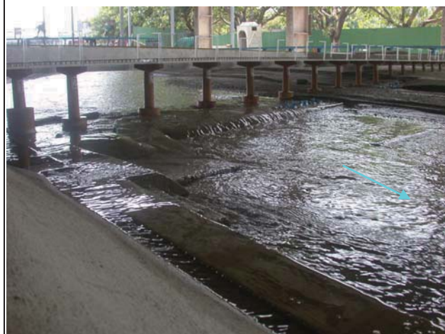
4.模型新山線鐵路橋下游高水位流路
