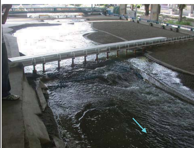
5.洪峰流量 4,007 秒立方公尺 (新山線鐵路橋 上下游)
