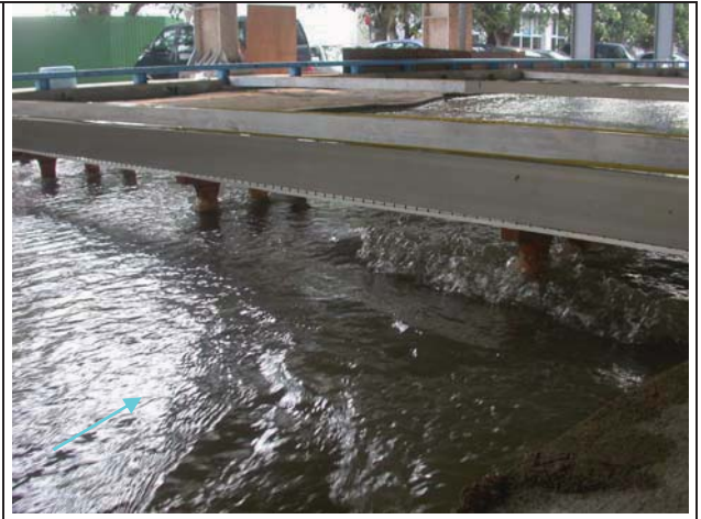
8. 試驗流量通過后豐橋流況
