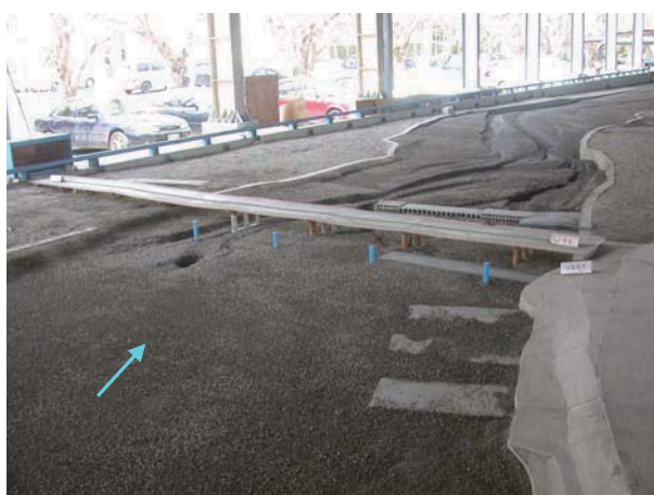
27.試驗後地形（后豐橋上游正隆護岸丁壩）
