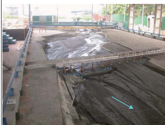
11. 試驗後新山線鐵路橋上下游情況
