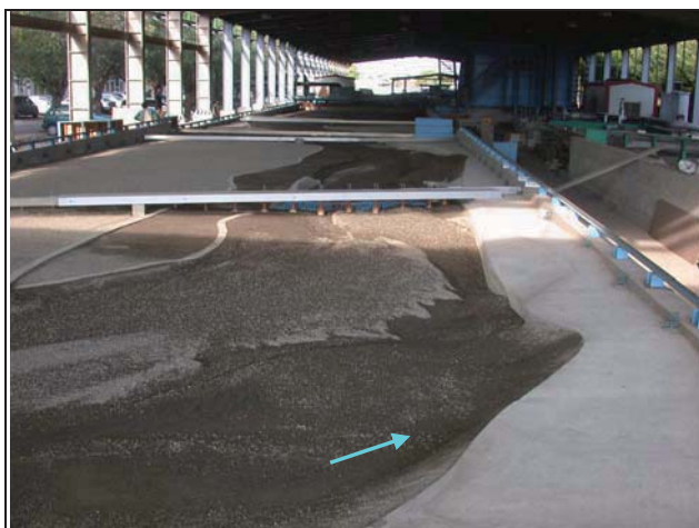
7.試驗後地形（新山線鐵路橋上游）
