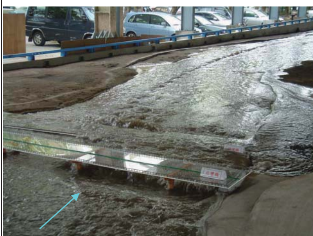
12. Q_{100}=8,800\text{cms} 通過后豐橋流況
