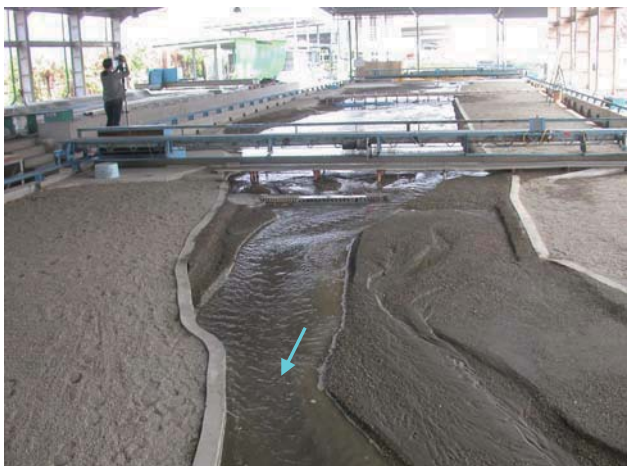
22.退水段 1,353 秒立方公尺 (后豐橋下游)
