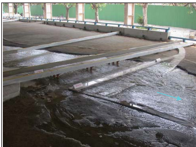
7. 試驗流量通過后豐橋流況
