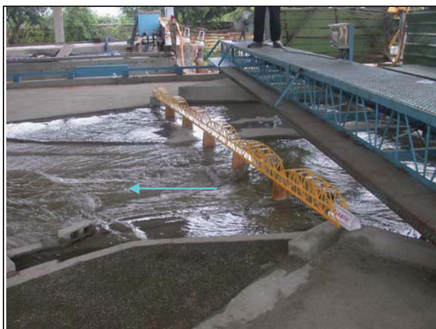
7. Q_{10}=5,000\text{cms} 通過舊山線鐵路橋流況
