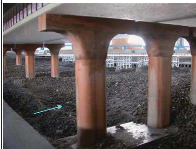
9.試驗後地形（后豐橋橋下）
