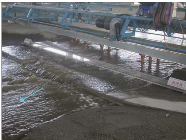
8. 試驗退水段 2,611 秒立方公尺通過后豐橋流況
