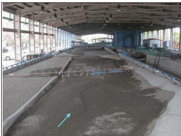
25.試驗後地形（新山線鐵路橋上游）
