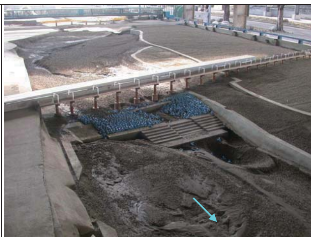
8.試驗後地形（新山線鐵路橋下游）
