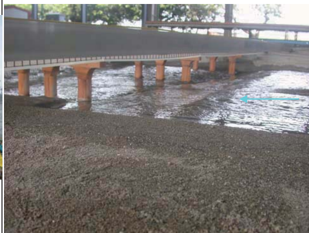
8. 模型后豐橋橋下高水位流路
