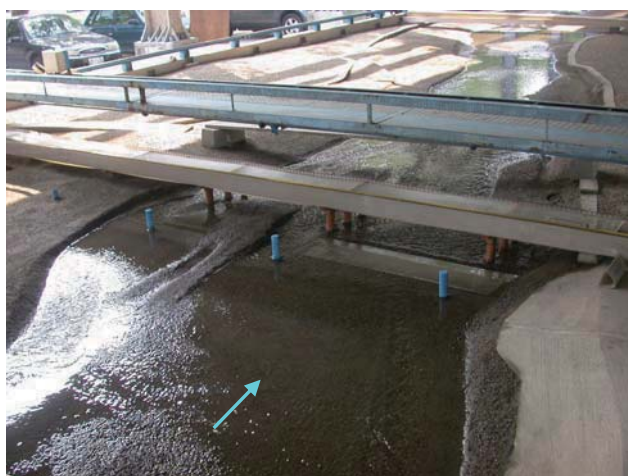
4.漲水段 266 秒立方公尺 (后豐橋上下游)
