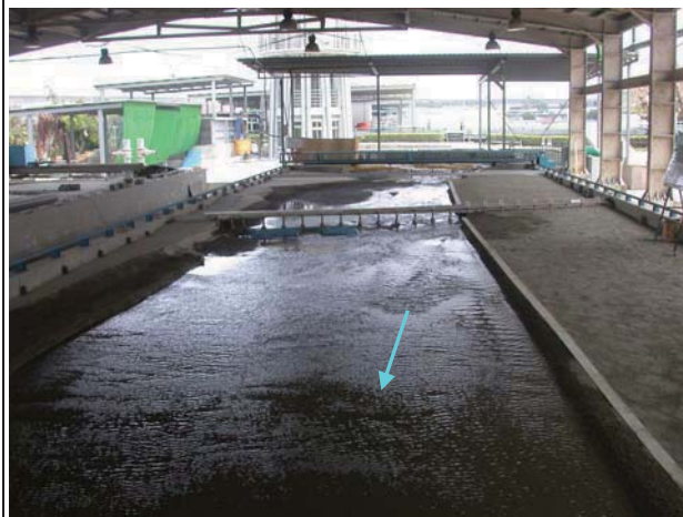
21.退水段 1,353 秒立方公尺 (新山線鐵路橋上下游)
