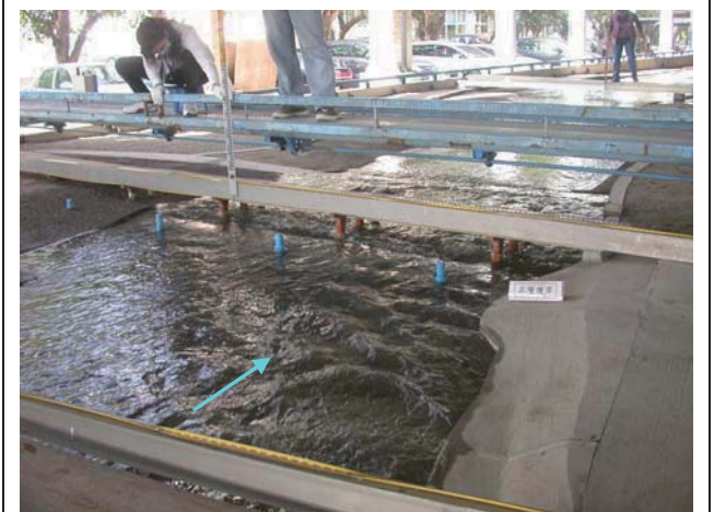
6.洪峰流量 4,007 秒立方公尺（后豐橋上下游）
