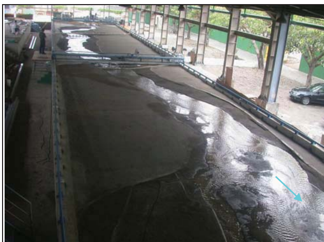
1. 試驗漲水段 710 秒立方公尺全斷面流況
