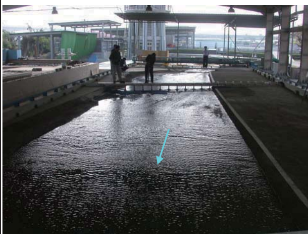
11.漲水段 2,948 秒立方公尺（新山線鐵路橋上 下游）
