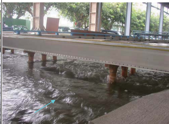
4. 試驗漲水段 2,480 秒立方公尺通過后豐橋流況
