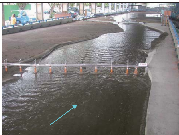
8. Q_{10}=5,000\text{cms} 通過新山線鐵路橋流況
