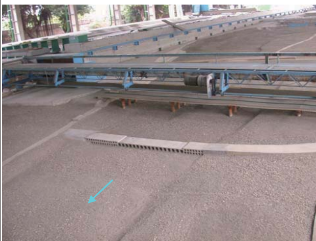
3. 試驗前地形（后豐橋下游臨時便道不拆除及便橋拆除）
