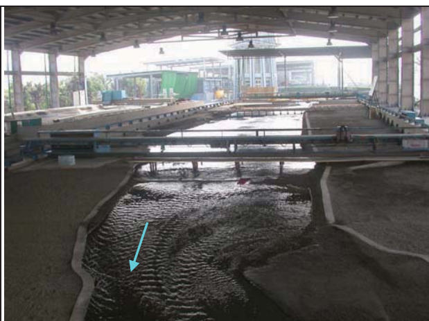
8.漲水段 1,353 秒立方公尺（后豐橋上下游）
