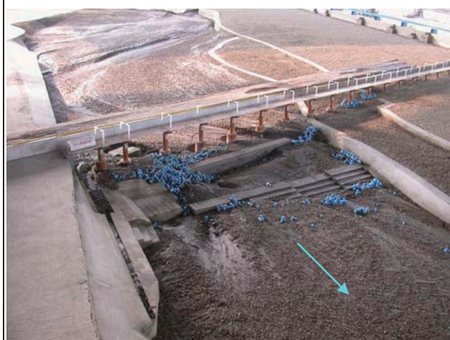
9.試驗後地形（新山線鐵路橋上下游）
