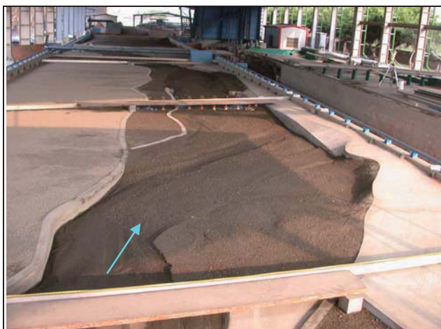
7.試驗後地形（舊山線鐵路橋下游）
