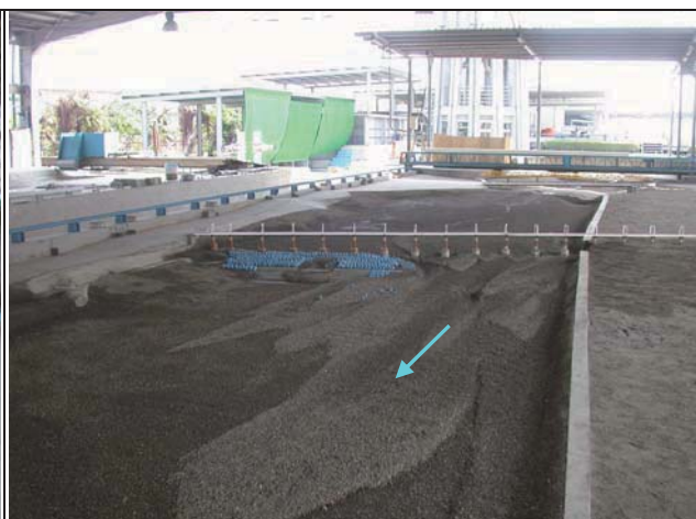
26.試驗後地形（新山線鐵路橋上下游）
