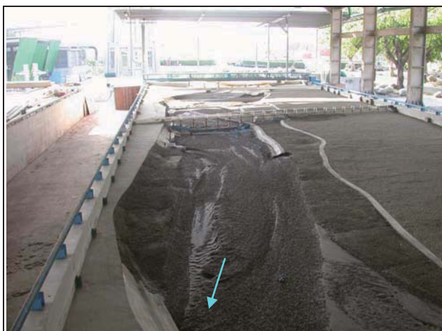
7.試驗後地形（舊山線鐵路橋下游）
