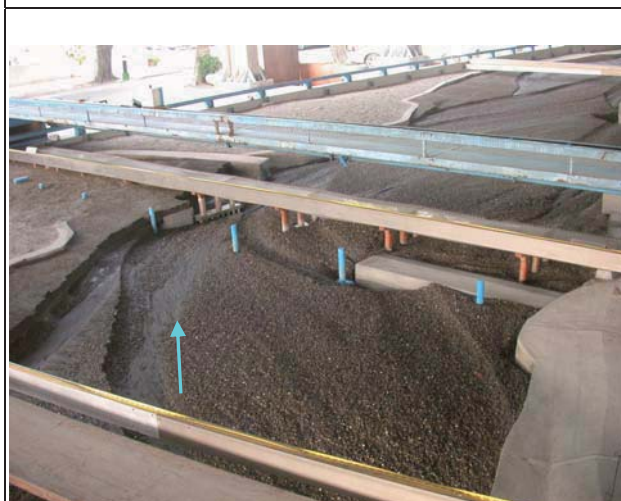
11.試驗後地形（后豐橋上下游）
