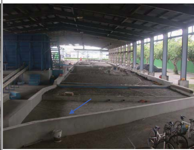
10.完成模型地形塑造過程（面向上游）
