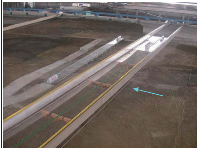
3. 后豐橋模型試驗前上游地形情況
