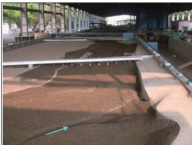
7.試驗後地形（新山線鐵路橋上游）
