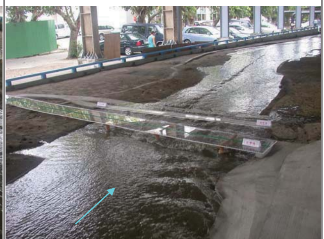
6. Q_5=3,800\text{cms} 通過后豐橋流況
