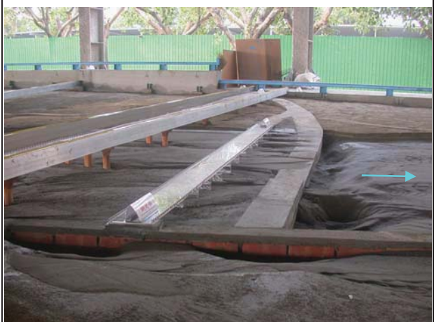
12. 試驗後后豐橋下游情況
