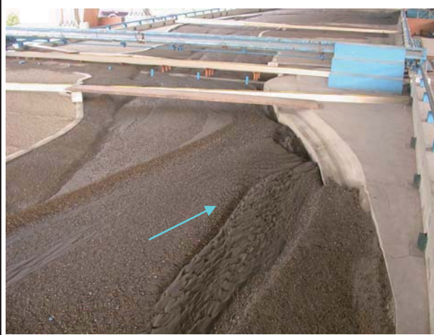
10.試驗後地形（后豐橋上下游）
