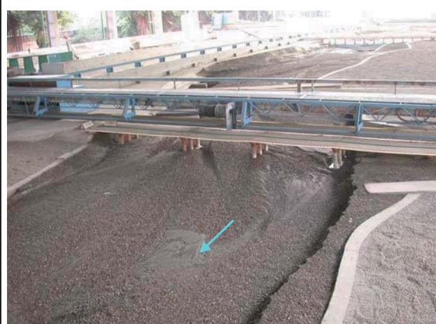
12.試驗後地形（后豐橋下游臨時便道拆除處）
