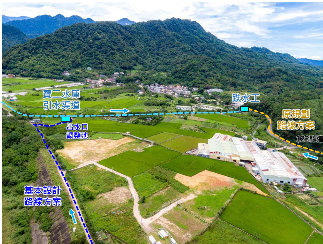
圖 4.2-9 放水口段原規線劃及基本設計方案路線空拍照片
