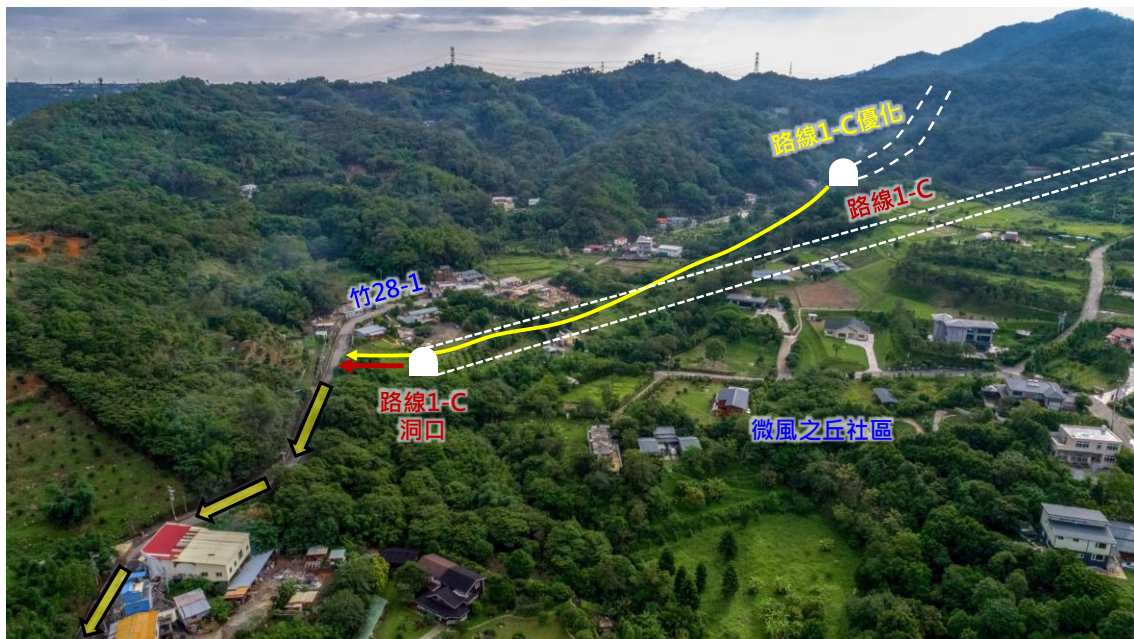
圖 4.2-3 隧道輸水管段隧道出口方案位置空拍圖
