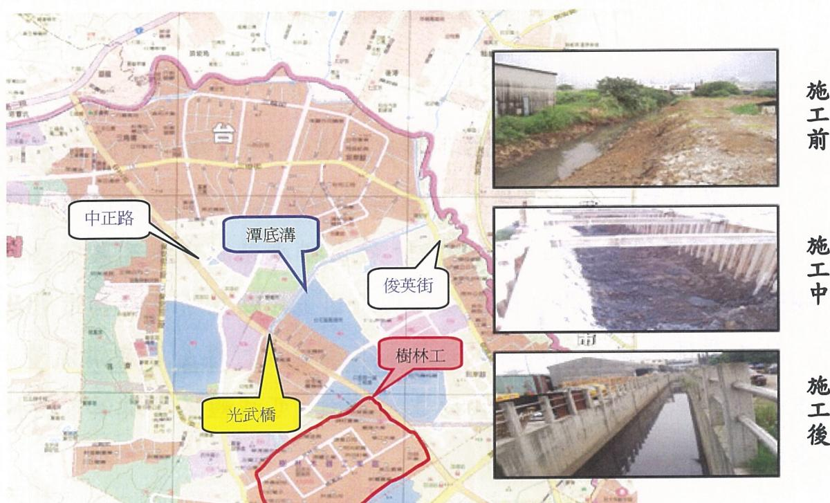
照片 3-4 潭底溝光武橋瓶頸打通及其上下游河道改善工程
