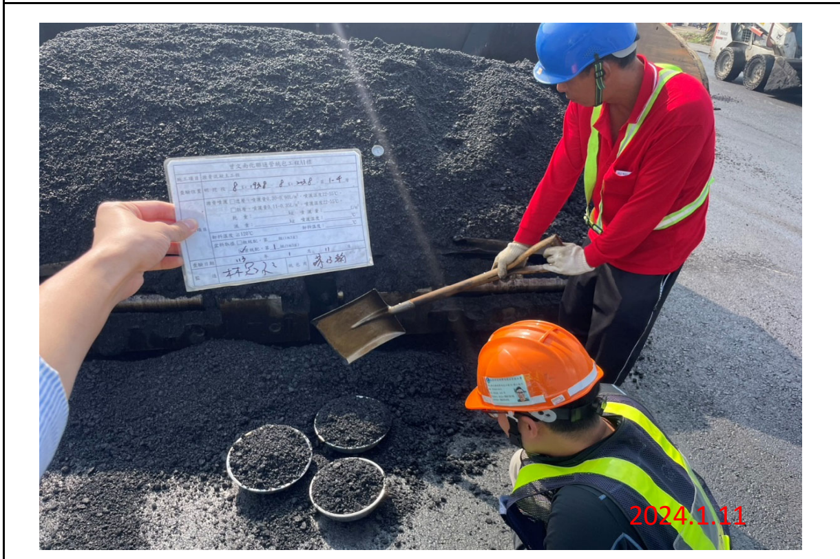
於113年1月11日曾庫公路推進段工程W09工作井8K+193.8-8K+203.8第3~4層AC鋪築，辦理AC盆料(含油量篩分析及夯打試驗)取樣密級配1組
