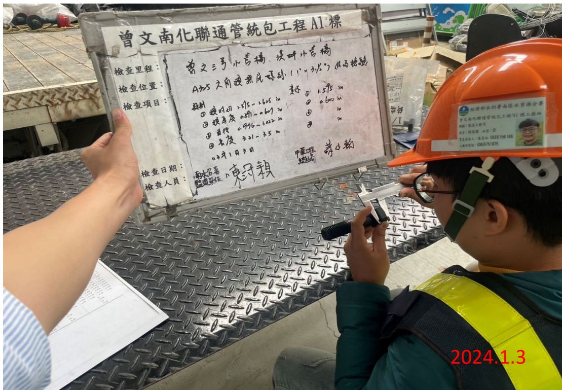
於112年1月3日 PRO操作風速過高改善工程進場查驗，鋼支保 G150，17組；鋼支保 G200，51組
