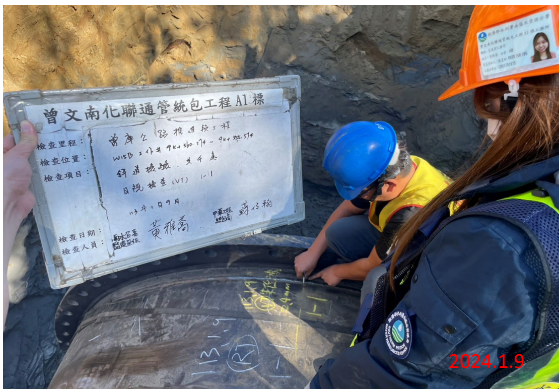
於112年1月4日至曾庫公路推進段工程W15B工作井辦理SP鋼管鋼道檢測 (VT、RT)
