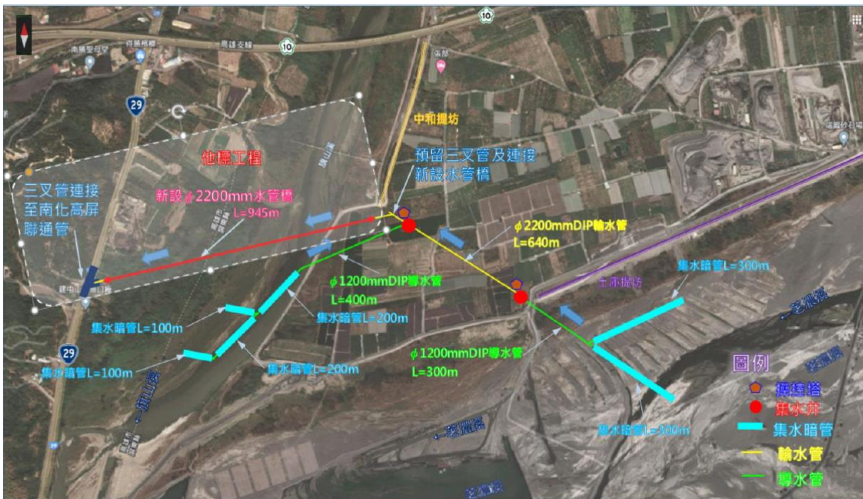
圖 1.1-1 荖濃溪（里嶺）伏流水平面配置圖
