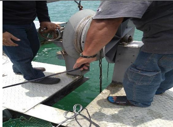
施作後(探頭吊放與率定測試)
