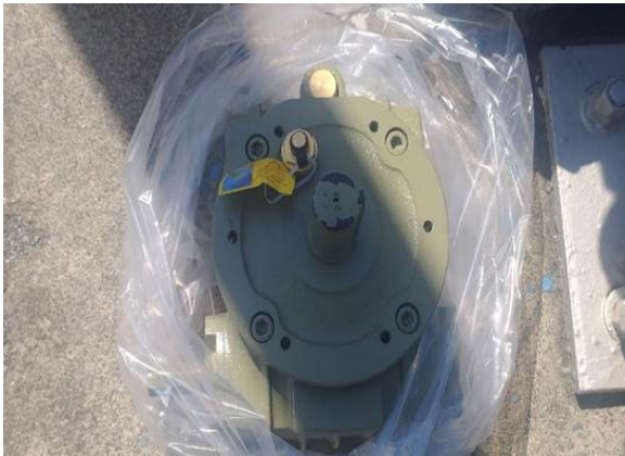
安裝開度計減速機
