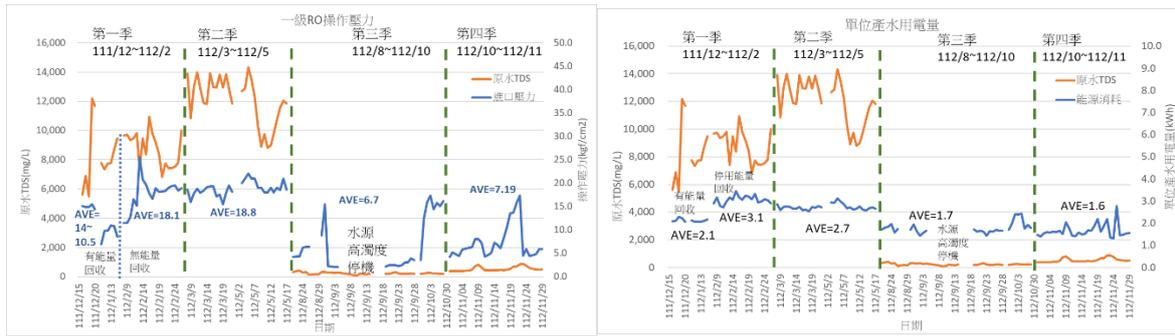
摘圖 4 原水 TDS、進流壓力及單位產水用電量分析圖
