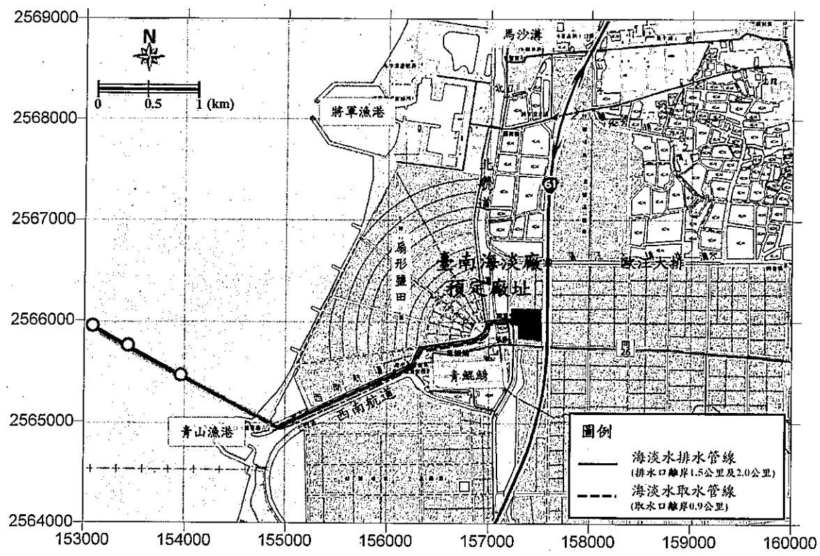
圖 4-2 取排水管線平面配置圖
