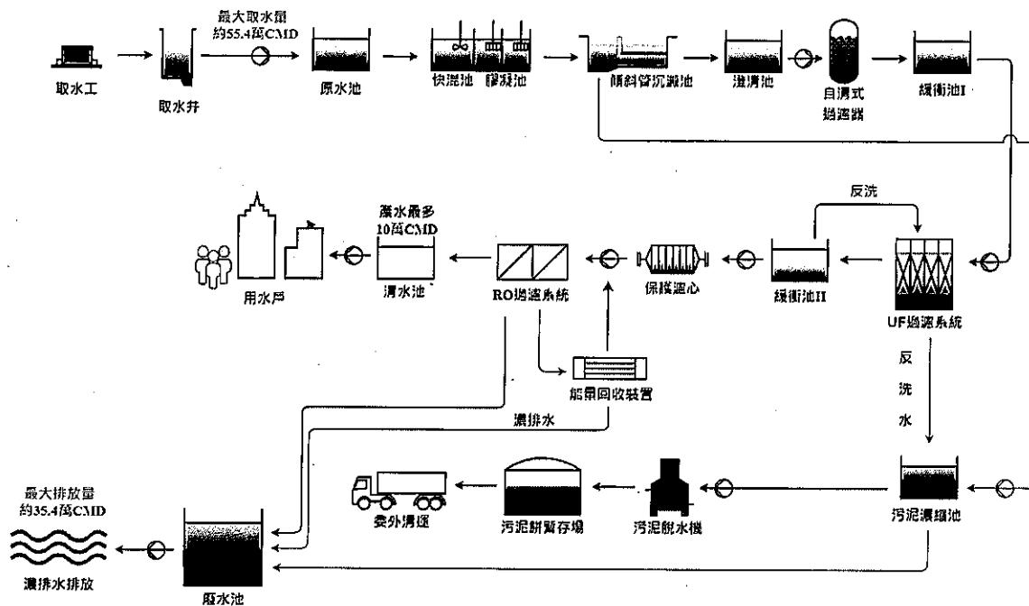
圖 4-3 臺南海水淡化廠處理流程示意圖
