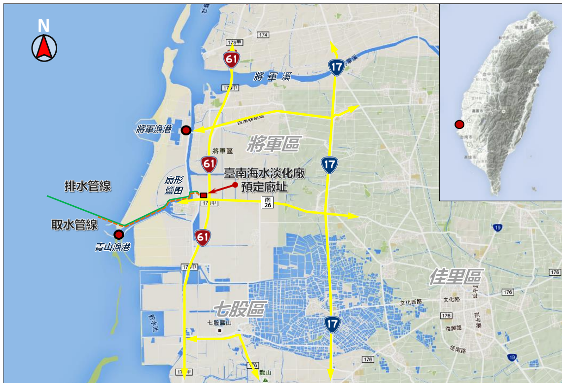
圖 1-1 臺南海水淡化廠預定廠址位置圖
