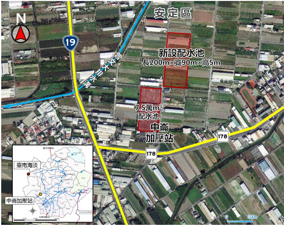
圖 4-29 中崙加壓站新設配水池
