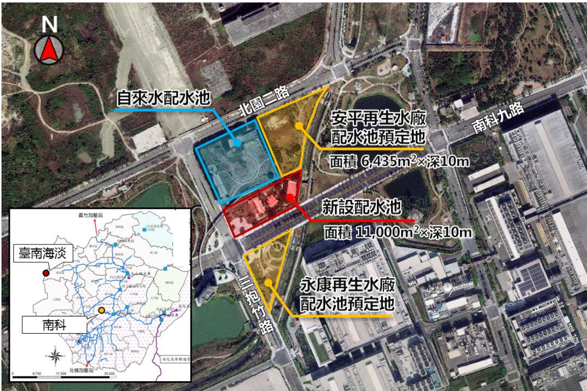
圖 4-30 南科新設配水池
