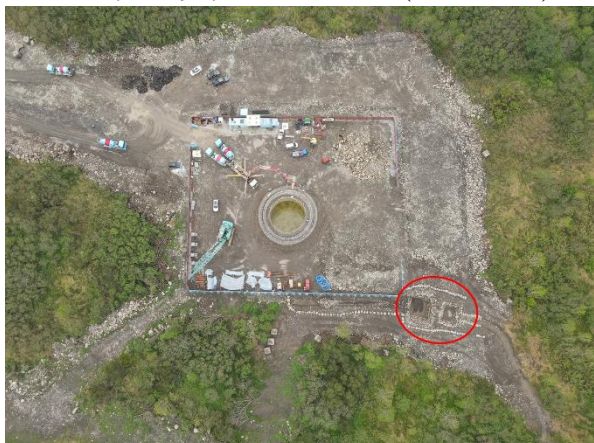
集水井下游側設置臨時沉砂池 (紅圈處)(114/3/27)
