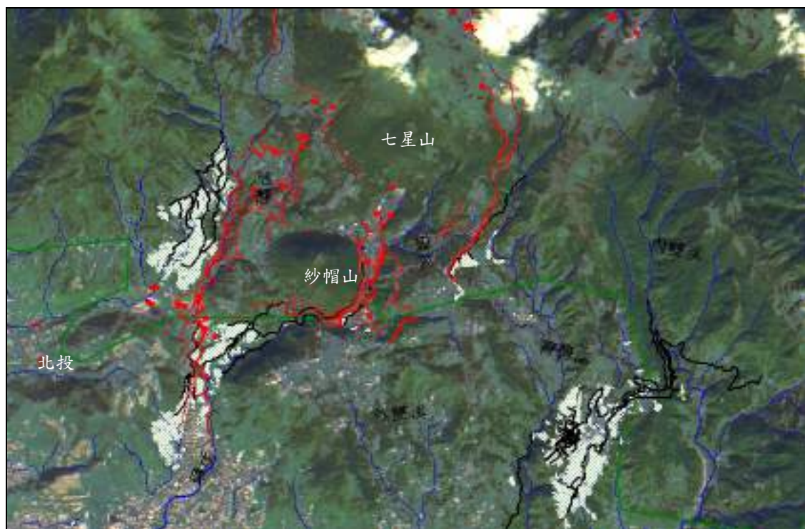
圖 6-4 陽明山地區溫泉管線、圳路與灌溉區分佈圖 (●：溫泉露頭(引水點)；紅色線為溫泉管線，大多冷熱管一起；黑色線為圳路；▨為灌溉區)
