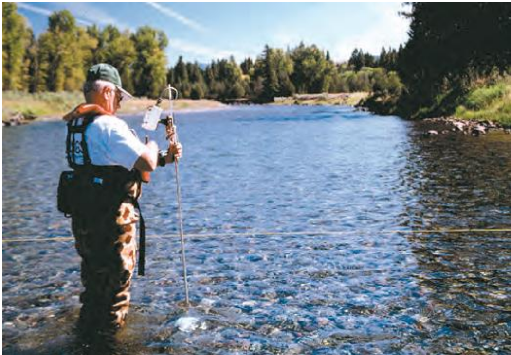
圖4-22USGS人員小水深以電子水尺進行量測
