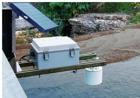
圖4-18RLR-0003雷達波水位計
