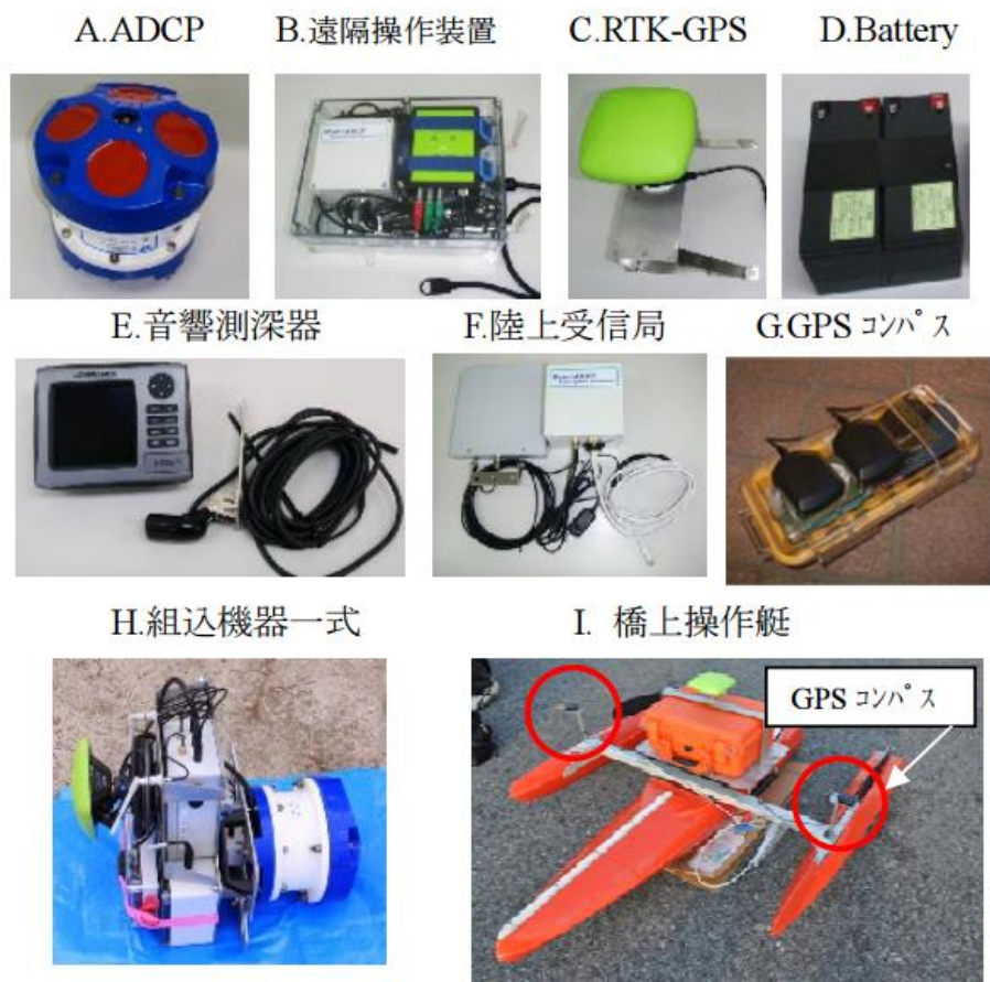
圖4-103ADCP洪水測量構成
