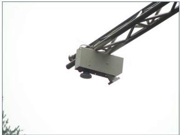
圖4-41RG-24非接觸雷達流量計於大陸應用情況
