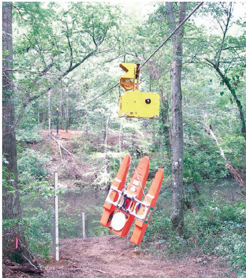
圖4-28 USGS人員於遠端操作纜線牽引ADCP自動施測流量
