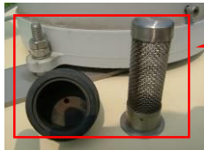
圖 6-7 雨量站維護保養步驟 2：雨量筒檢視與維護(2/2)
