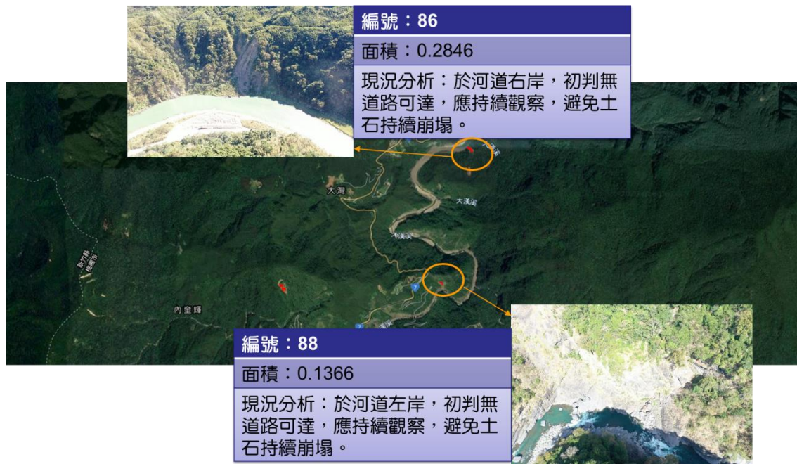
圖3-21 石門水庫集水區須關注之崩塌地位置(編號 86 及 88)
