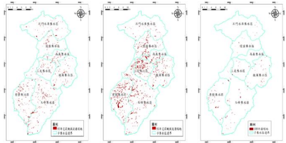
圖 1 石門水庫集水區歷年崩塌位置
