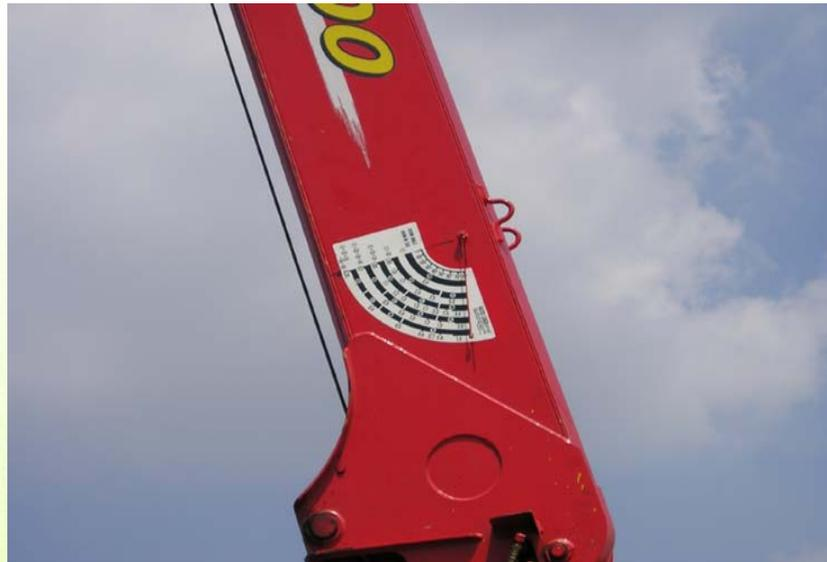
具有伸臂之移動式起重機應於操作人員易見處設置伸臂傾斜角之指示裝置，以防過負荷操作。
