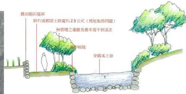
■ 下湖橋至蘭陽發電廠段堤岸 現況示意剖面圖
