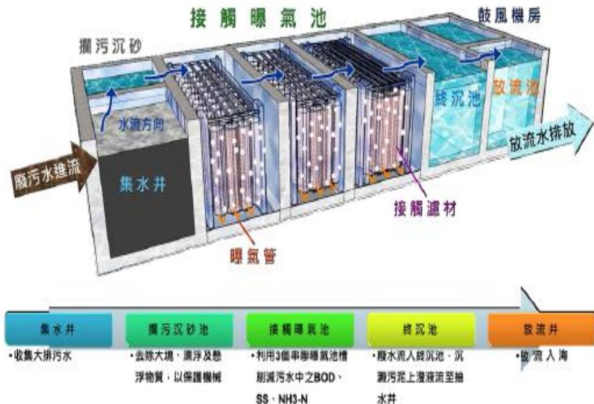
圖 7 簡易場鑄式污水處理設施及處理流程示意圖
