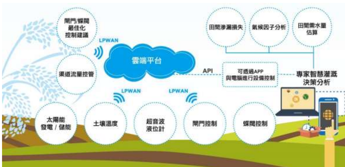
圖 3.46 智慧灌溉系統架構
