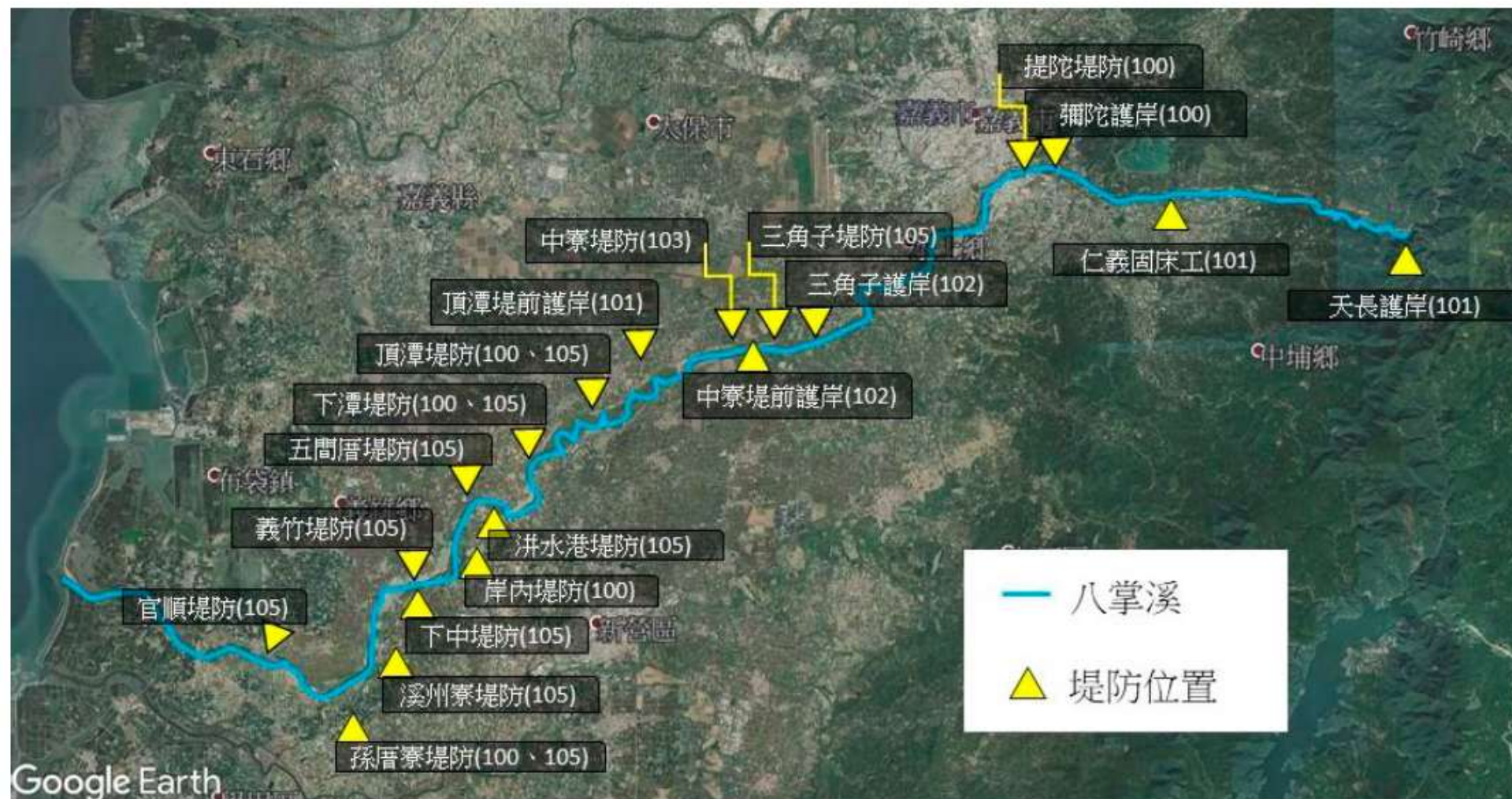
圖 3.4 近年來(民國 100 年以後)較常發生損壞與災修的堤岸位置分布圖
