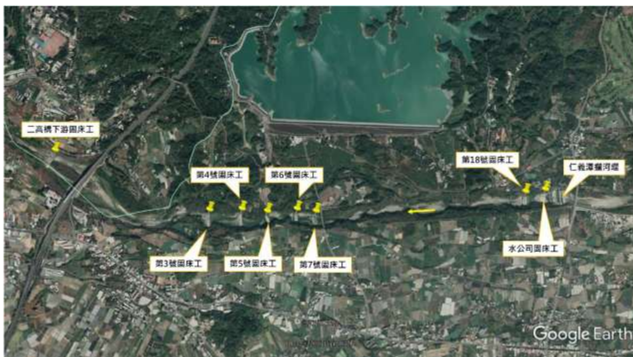
圖 2.41 八掌溪現有 7 座固床工位置示意圖
