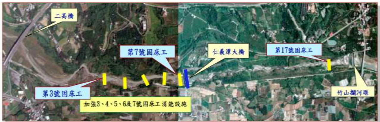
圖 3.9 八掌溪仁義潭大橋下游既有固床工改善示意圖
