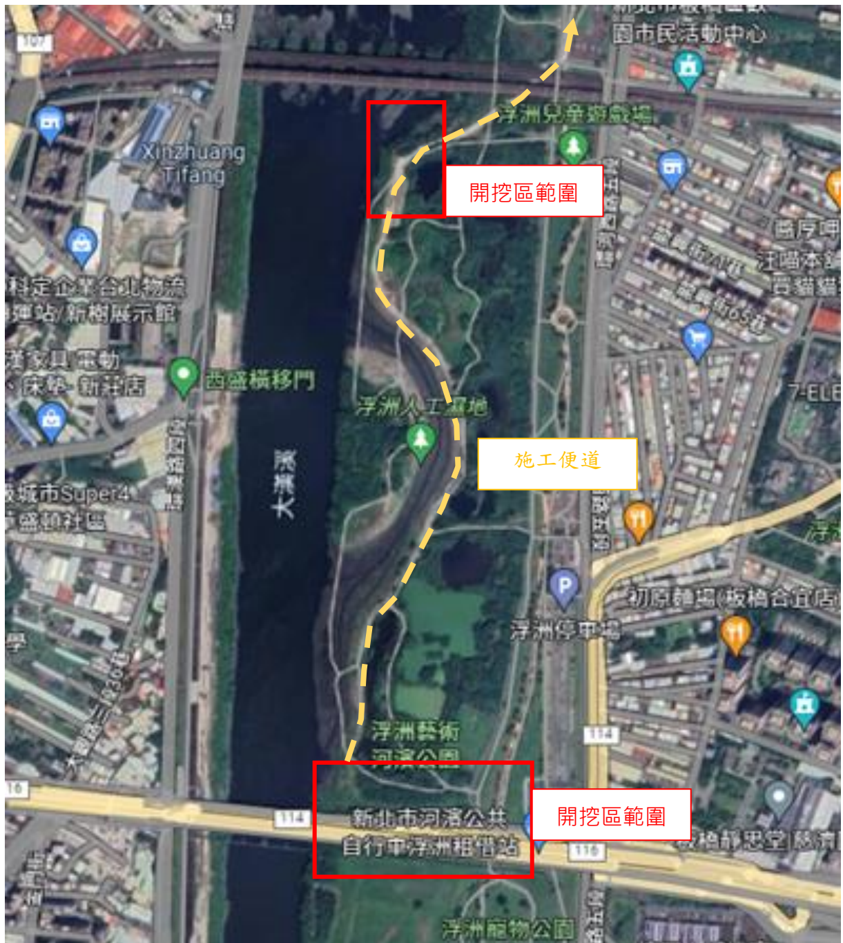
圖 6-2 工區內施工動線及開挖範圍管制圖
