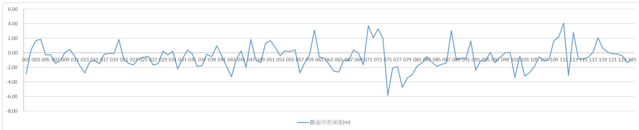
圖8 龜重溪110年與99年大斷面測量河道沖淤深度變化示意圖
