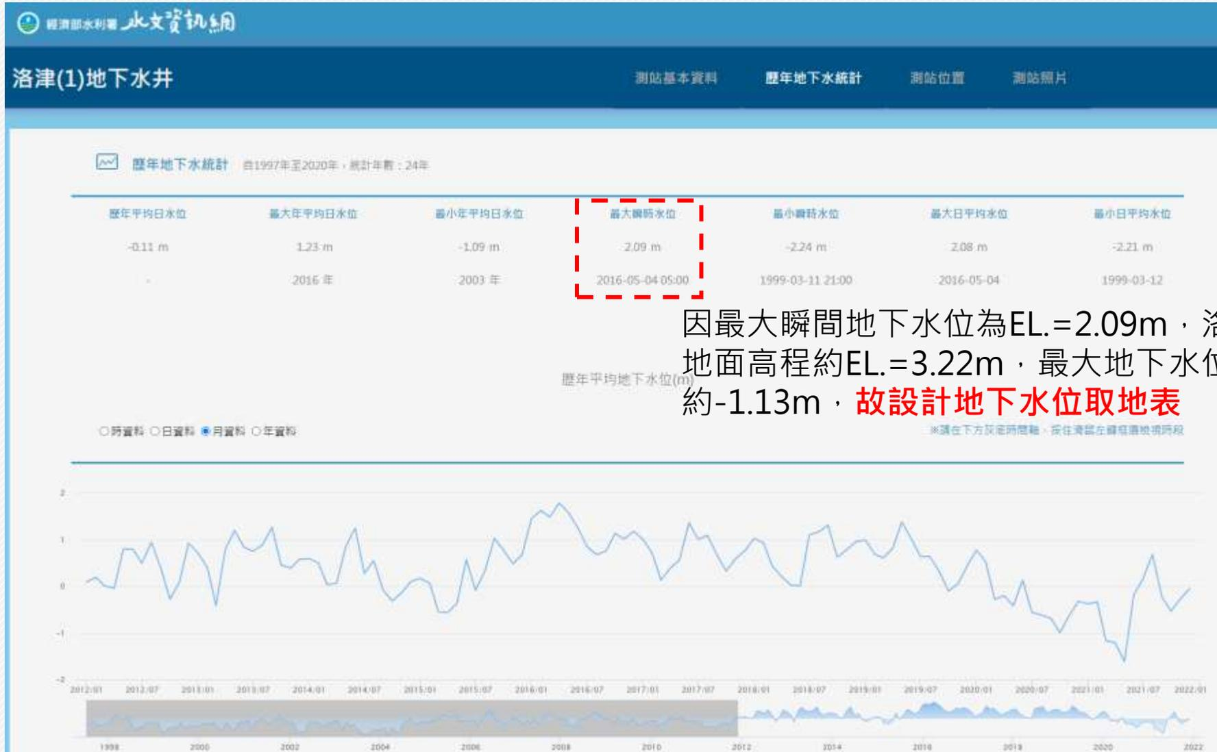
因最大瞬間地下水水位為EL.=2.09m，洛津國小地面高程約EL.=3.22m，最大地下水水位距地表約-1.13m，故設計地下水水位取地表
