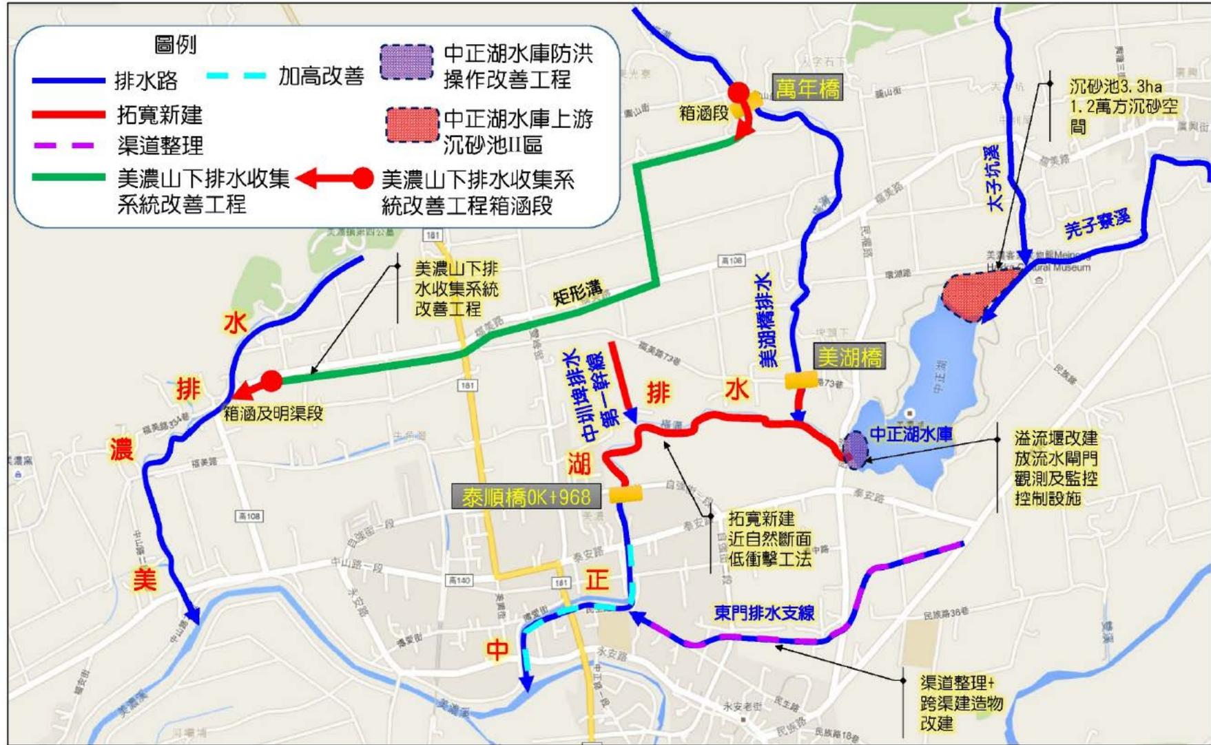
圖 2-14 美濃湖排水計畫相關工程布置位置示意圖
