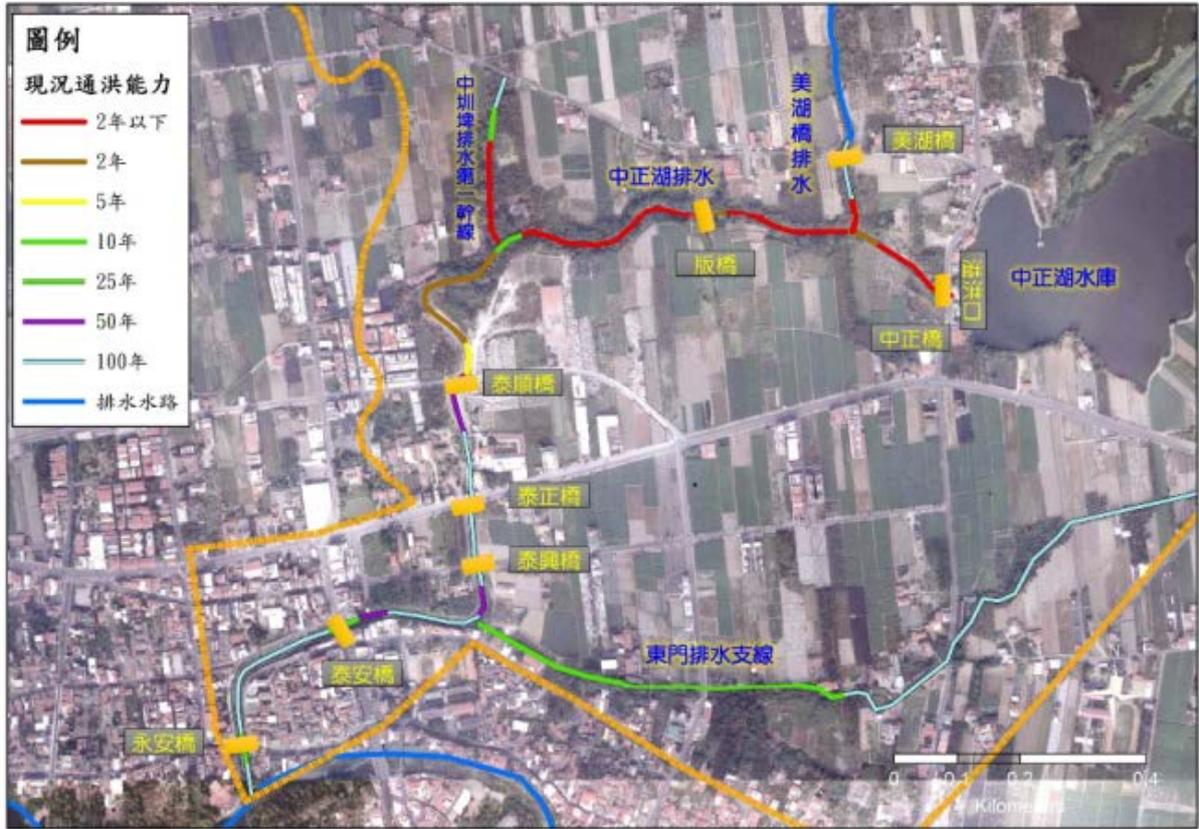
圖 3-12 美濃湖排水系統治理計畫工程完成前通洪能力圖
