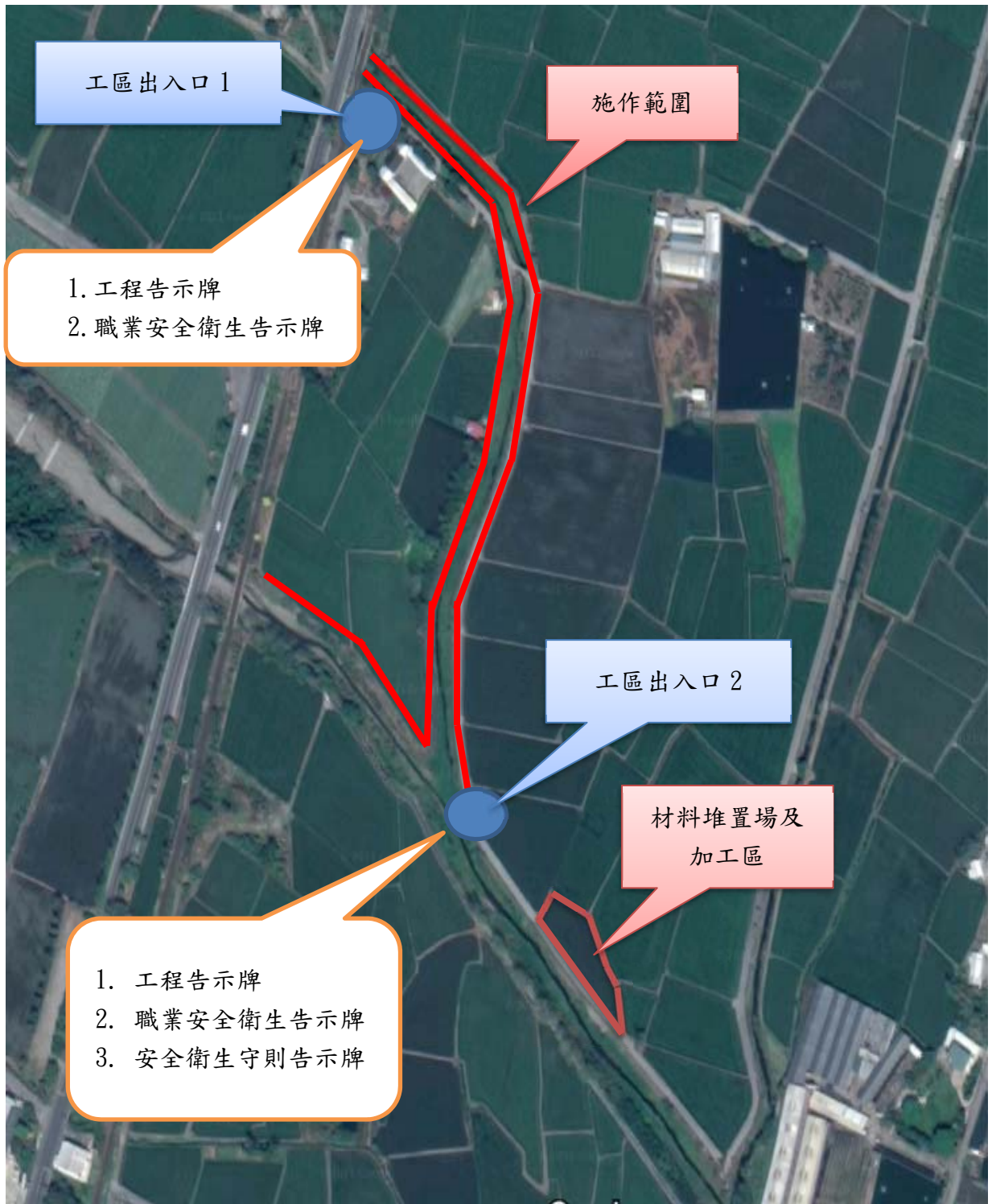
圖 6-1 材料堆置場及加工場配置與施工動線圖
