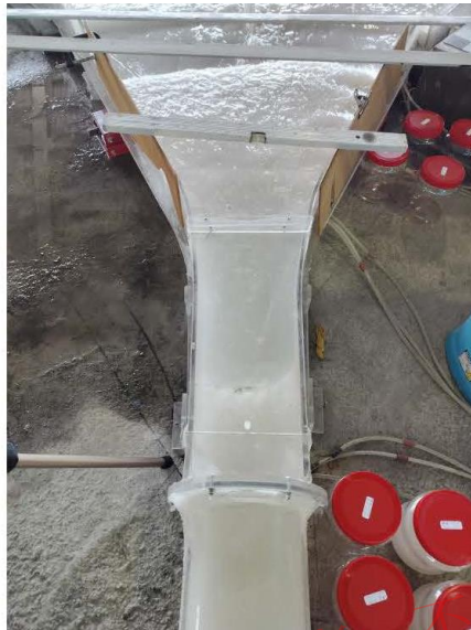
摘照4-1-8 方案一隧道入口滿管迴溯
