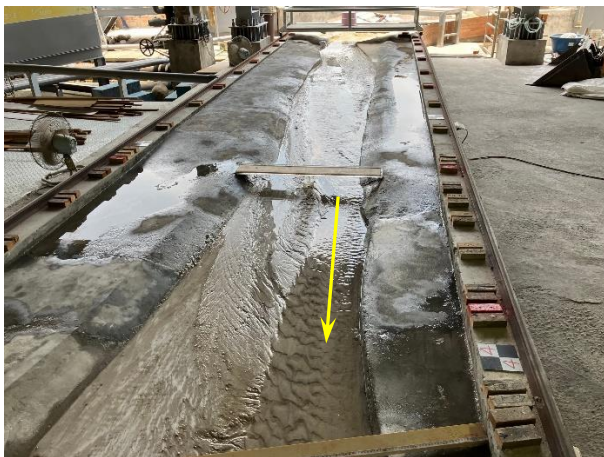
照片 4-2-7 方案二加砂試驗後油庫一號橋 照片 4-2-8 方案二加砂試驗後分洪堰及 上下游流路 攔河堰前庭淤砂情形
