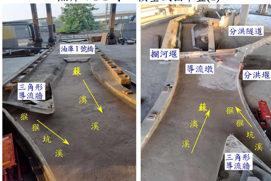
照片 4-1-2 水工模型試驗布置(2)
