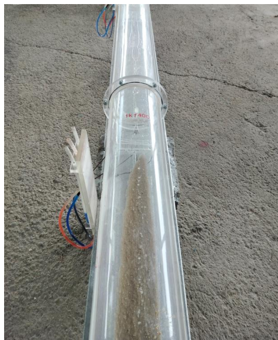
照片 4-1-13 方案一隧道 1k+400 試驗後淤砂分布
