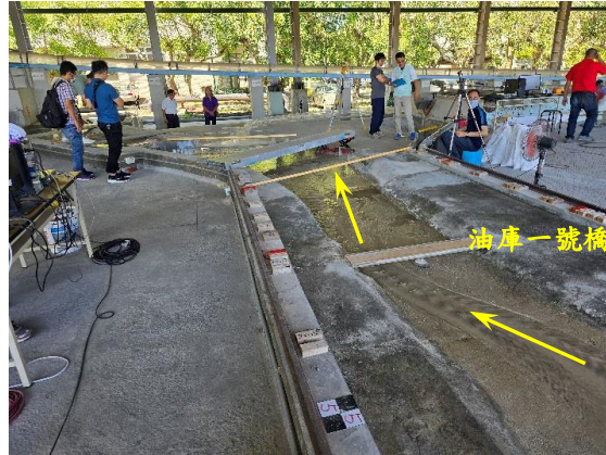
摘照4-2-1 方案二加砂試驗油庫一號橋 上下游低水流路(流量32cms)
