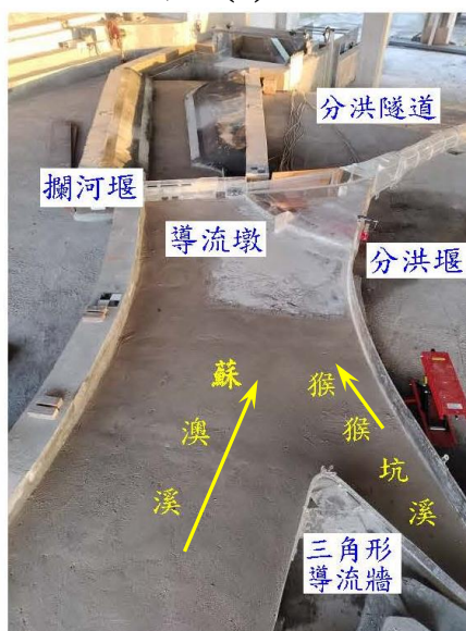
摘照4-1-2 水工模型試驗布置(2)
