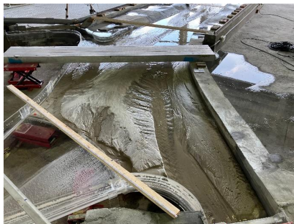
摘照片4-2-3 方案二加砂試驗後分洪堰 及攔河堰前庭淤砂情形
