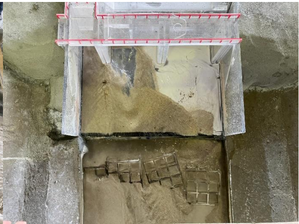
照片 4-2-10 方案二加砂試驗後攔河堰下游護坦工填料流失情形
