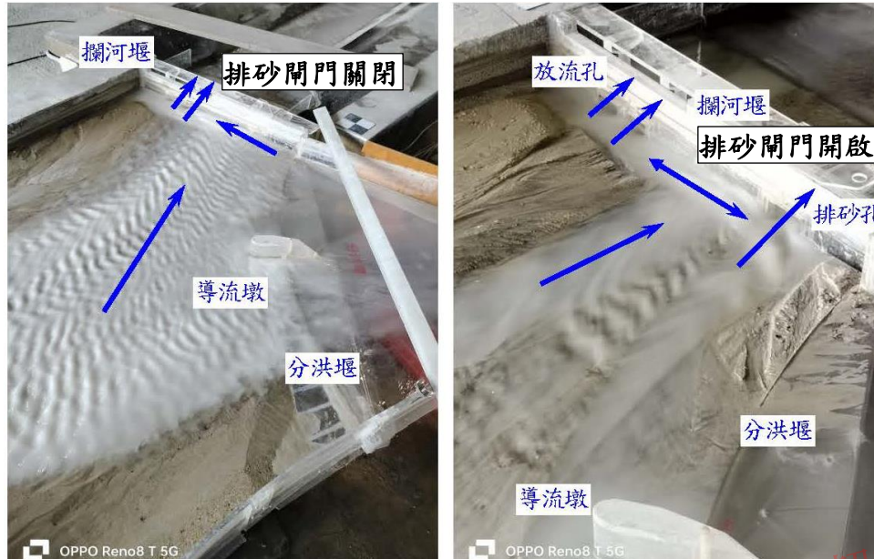
照片 4-1-7 方案一排砂孔開啟前後之流路變化
