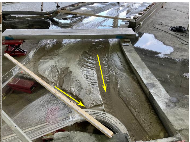
照片 4-2-7 方案二加砂試驗後油庫一號橋 照片 4-2-8 方案二加砂試驗後分洪堰及 上下游流路 攔河堰前庭淤砂情形
