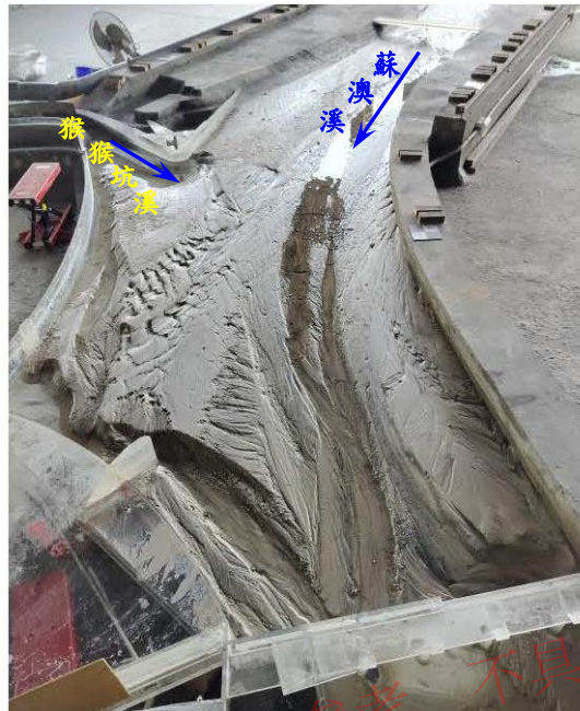
摘照4-1-7 方案一分洪堰及攔河堰前庭河道淤積
