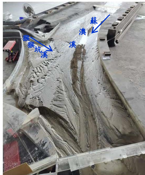
照片 4-1-9 方案一分洪堰及攔河堰前庭河道淤積
