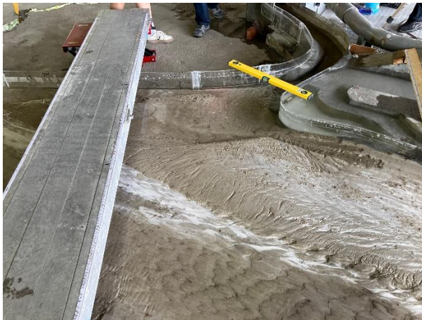
照片 4-2-9 方案二加砂試驗後蘇澳溪及猴坑溪匯流附近河床變化
