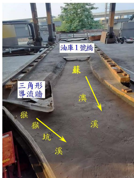
摘照4-1-2 水工模型試驗布置(2)
