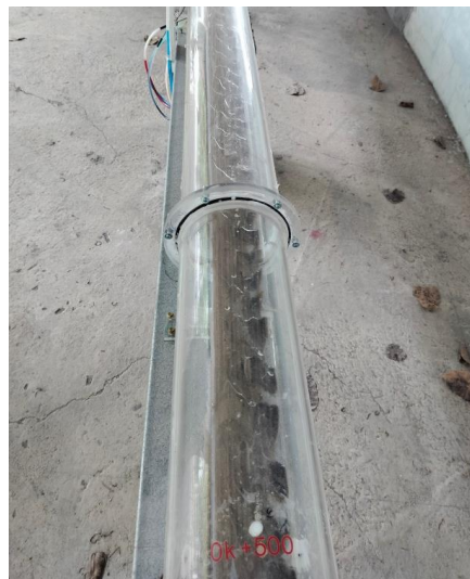
摘照4-1-9 方案一隧道0k+500試驗後淤砂分布
