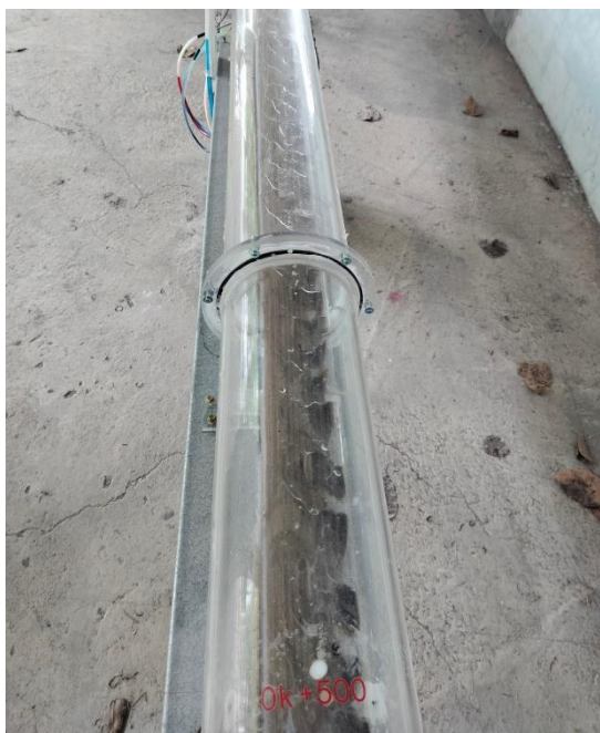
照片 4-1-12 方案一隧道 0k+500 試驗後淤砂分布
