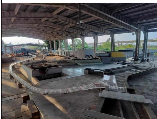
蘇澳溪分洪工程及河道定床模型 塑造完成
