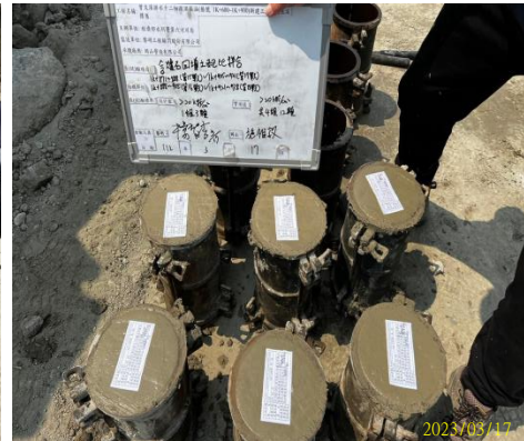
拌合材料試體製作
