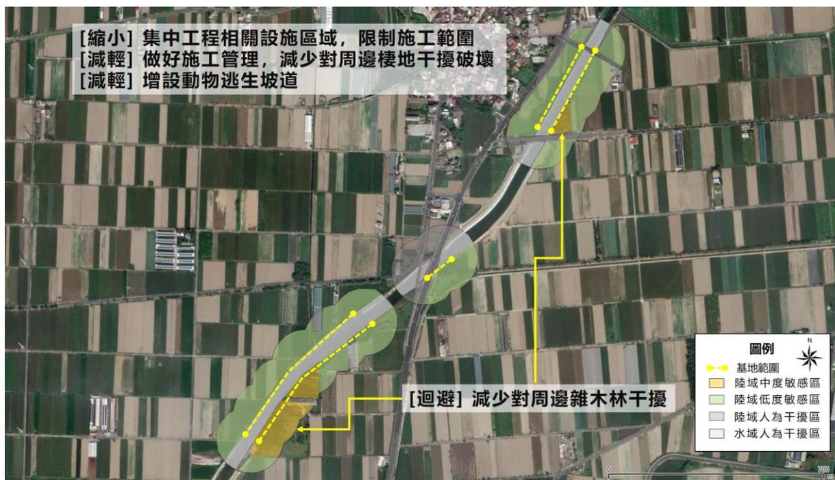
**圖 3.4.2-4 六腳排水(六腳橋下游段)治理工程生態關注區域圖**
