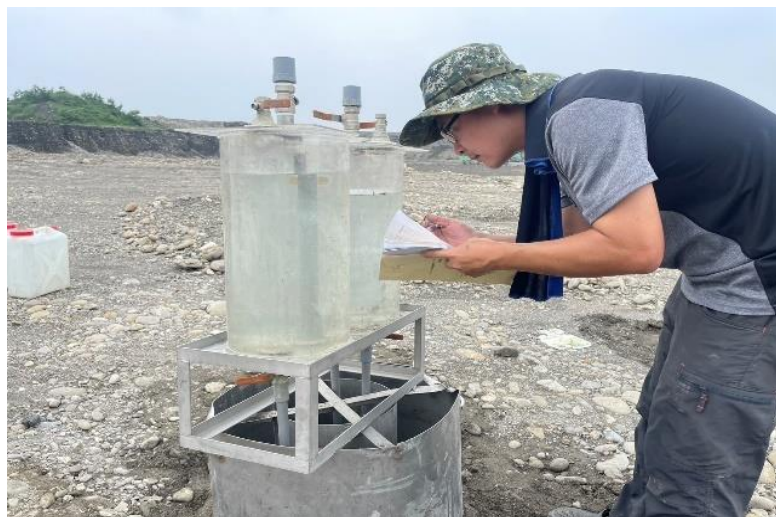
圖 9-3 濁水溪河槽補注設施雙環入滲試驗
