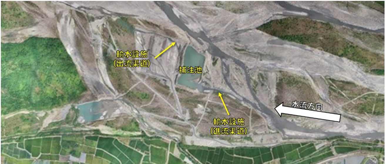
圖 6-1 河槽補注設施平面配置範例
