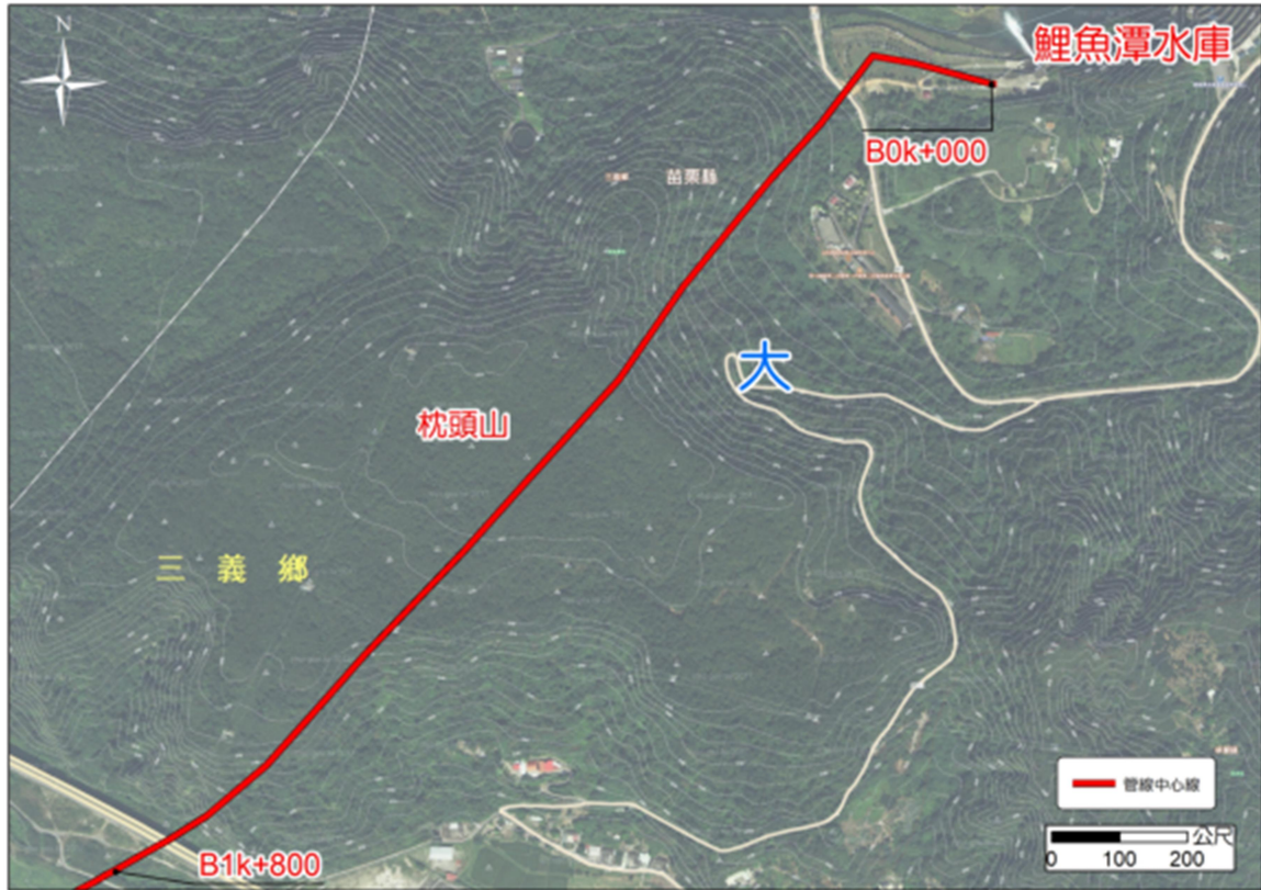
圖 1-4 鯉魚潭水庫第二原水管路線示意圖(1/2)
