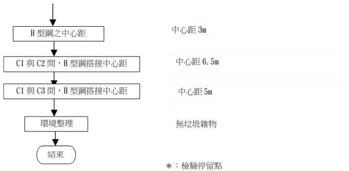
圖 4-24 牽引道(B)立柱及搭接施工檢驗流程圖(2/2)
