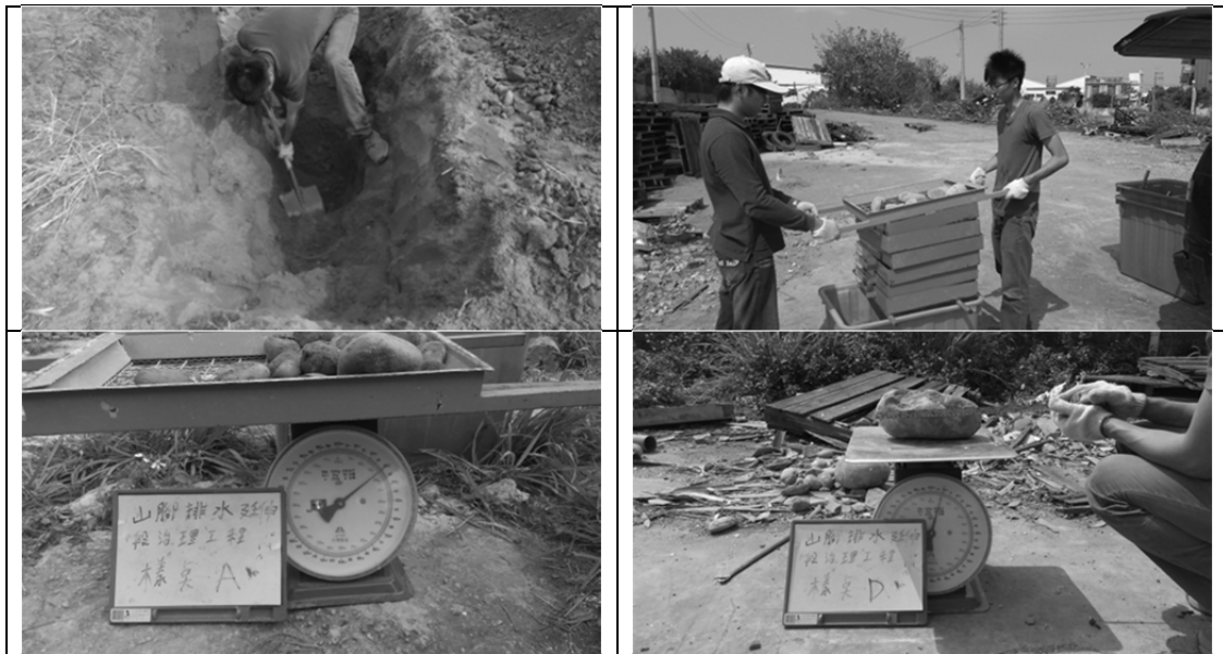
圖2-6-2 野外採樣篩分析試驗過程
