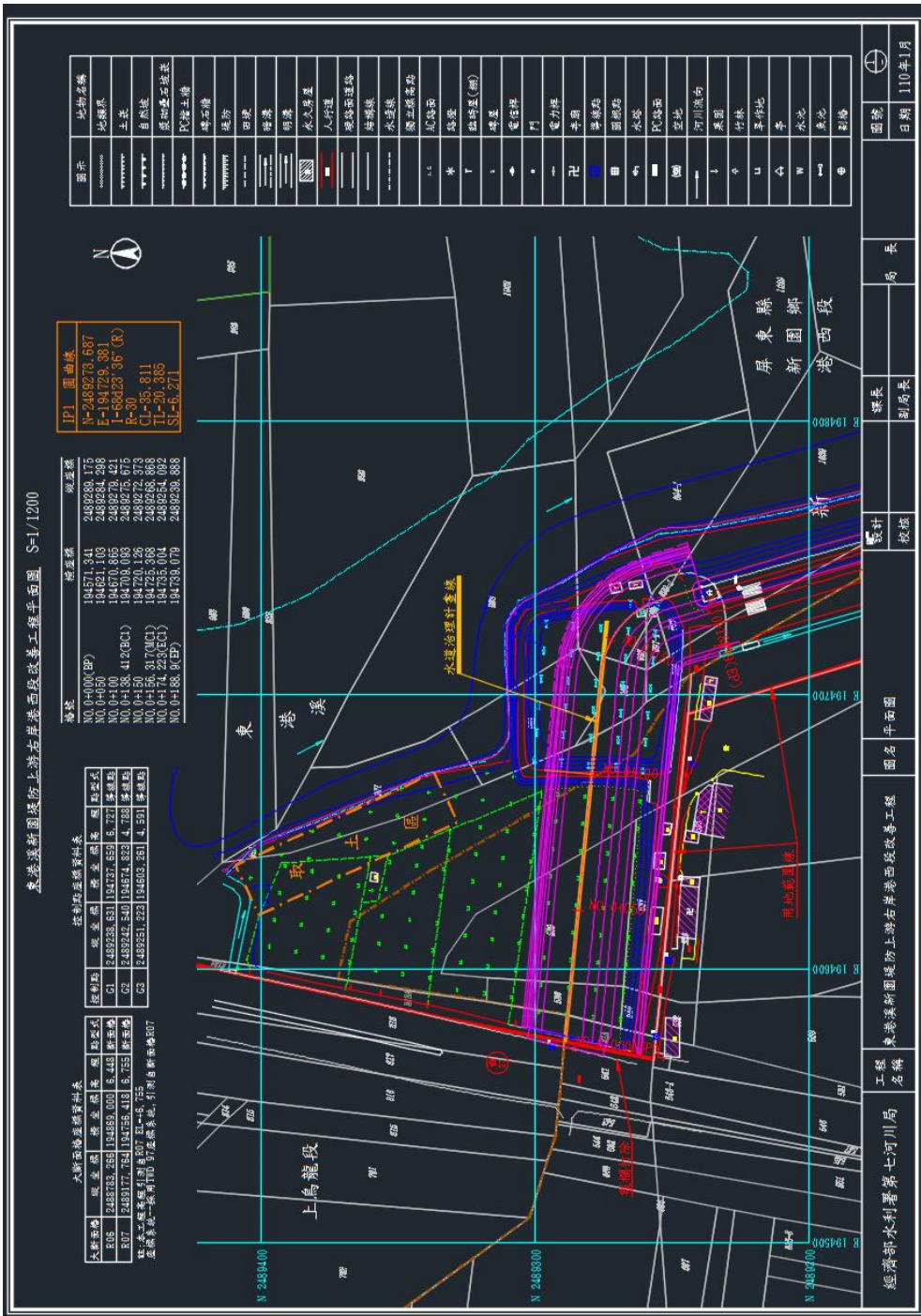
圖 1-2 東港溪新園堤防上游右岸港西段改善工程初步平面設計圖
