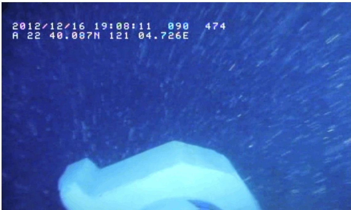
圖附件二-4 水下-475m 處發現有斷管
