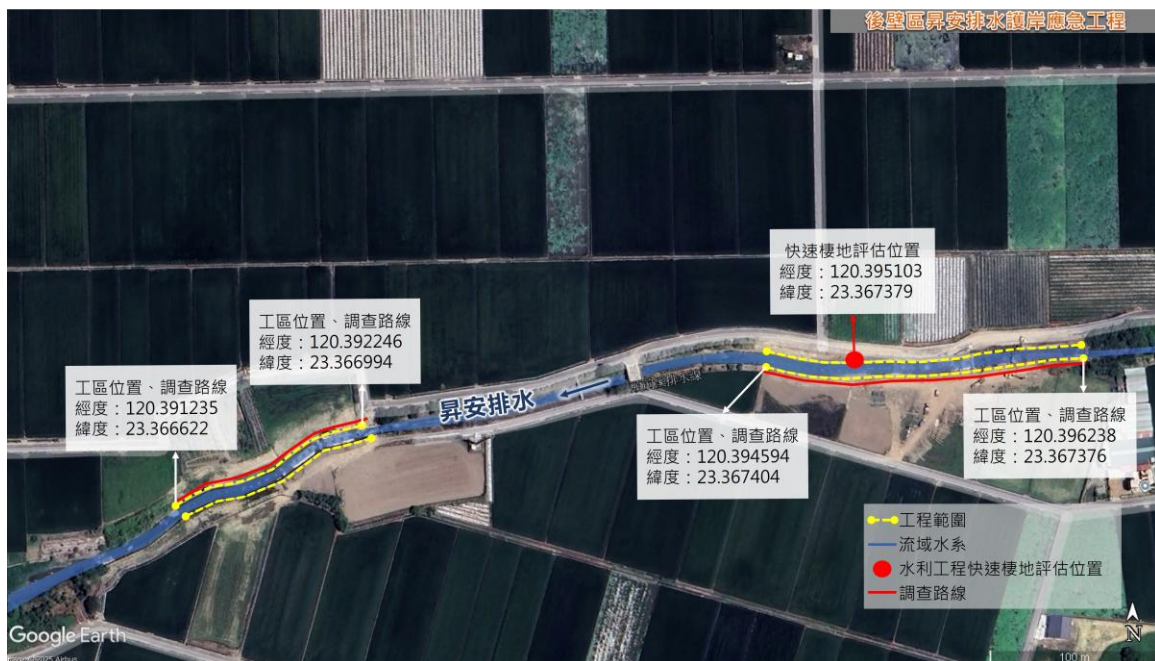
圖 3.3.3-1 後壁區昇安排水護岸應急工程範圍
