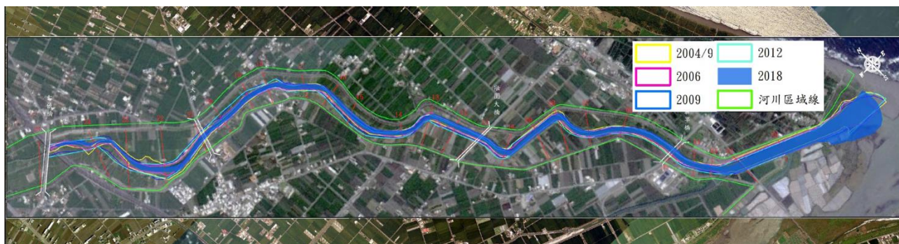
圖 2-52 流路直沖交替出現示意圖(蘭斷 13~24)
