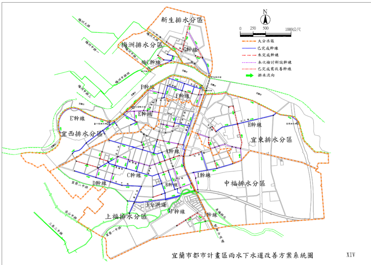
圖 2-56 宜蘭都市計畫雨水下水道系統圖
