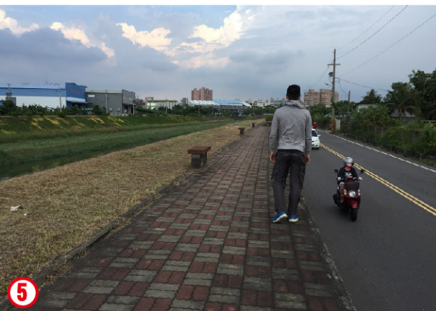
河華橋-前州橋河堤設有人行步道及景觀傢俱，惟臨路側高程落差大卻無設置護欄，現況植栽生長狀況不佳。
