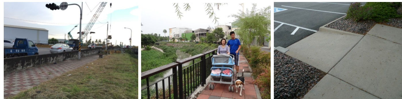
圖伍-37 現況步道與銜接道路無法貫通 以植栽帶分隔人行及車行空間 出入口高差無障礙設計
