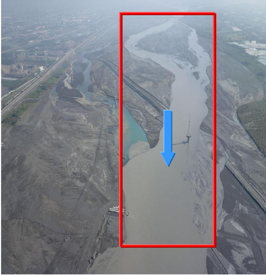
圖 7-4 荖濃溪里嶺大橋上游疏濬 200 萬立方公尺土石，以導正河心深槽流路增加通洪斷面。
