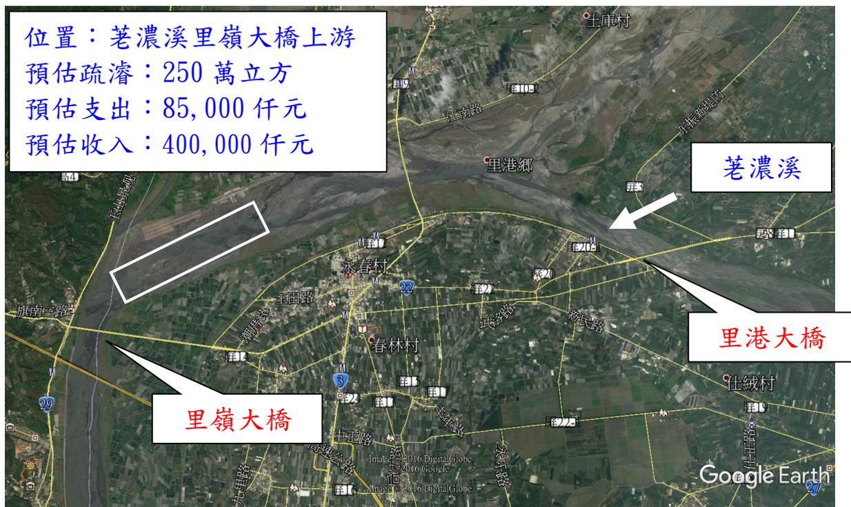
圖 7-1 第七河川局規劃囚砂區（荖濃溪里嶺大橋上游）
