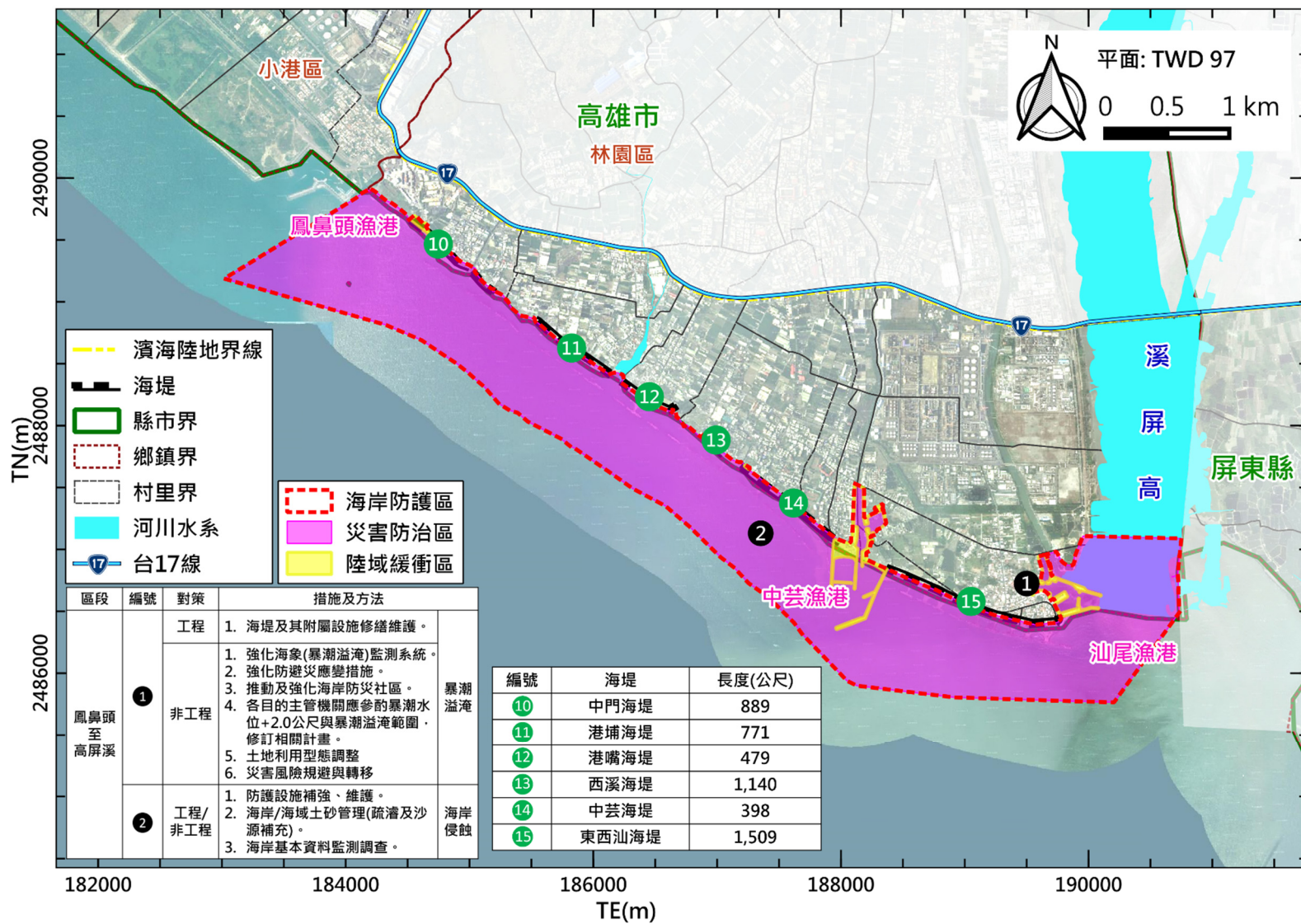
圖 7-3 高雄市一級海岸防護區海岸防護設施之種類、規模及配置圖(3/3)
