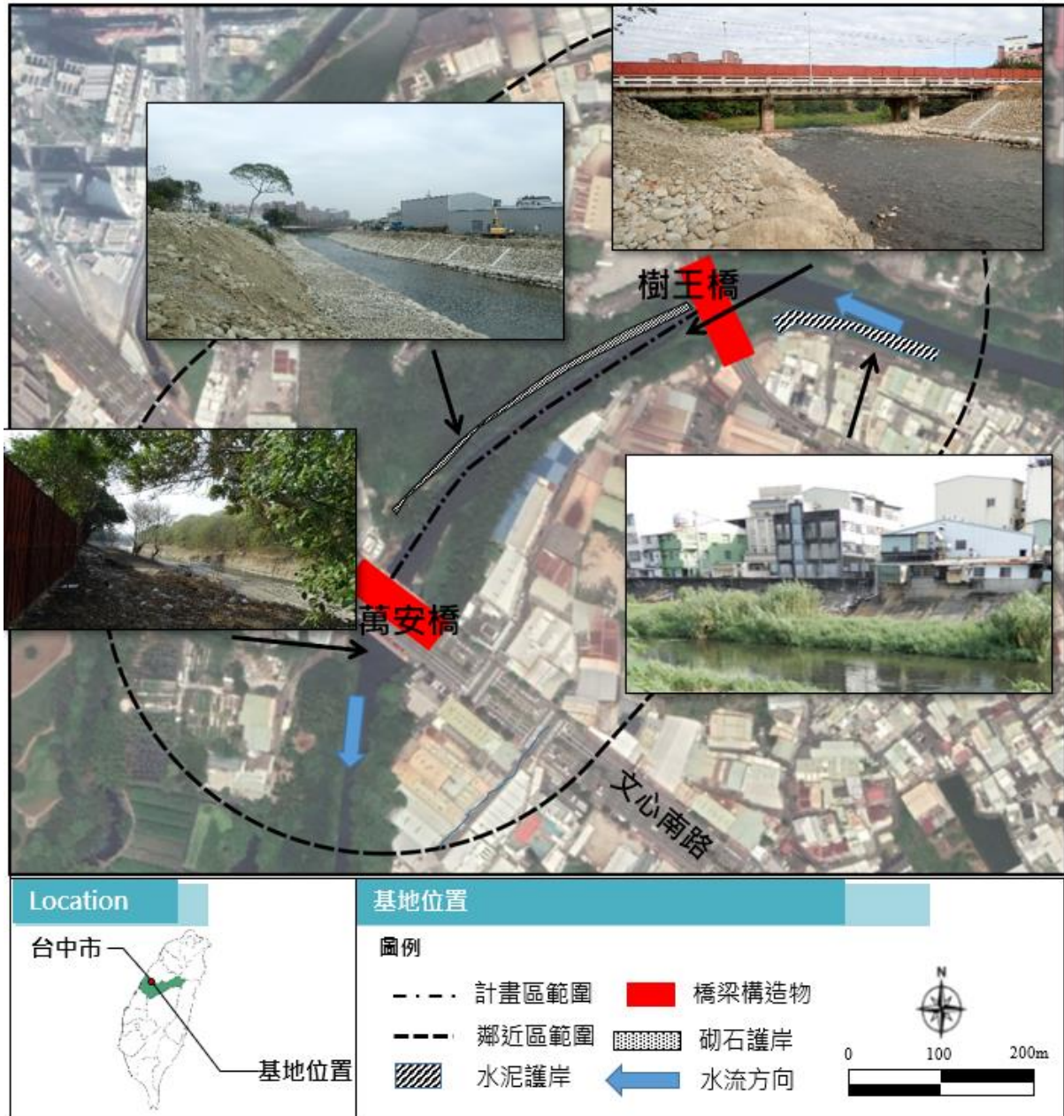
圖 5、早溪排水(萬安橋至樹王橋)整治工程施工中階段生態檢核人工構造物位置圖
