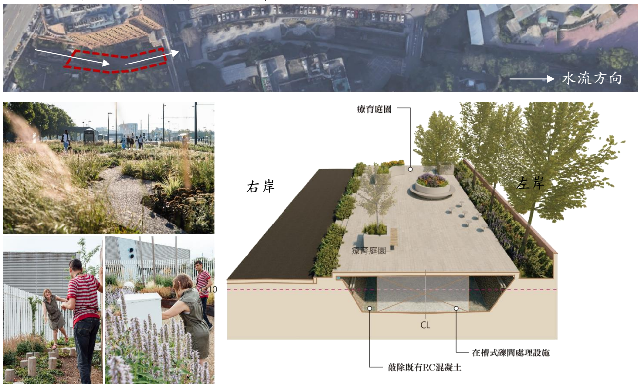
圖 27 普濟溪-上游段斷面設計說明示意圖
