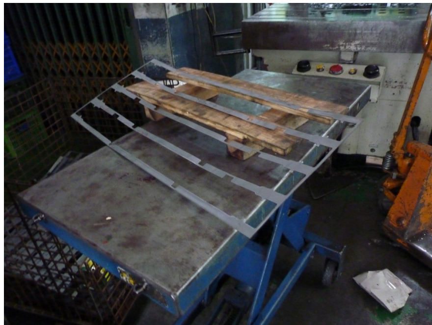
板材與模具衝剪過程需以人力 固定板材示意。
