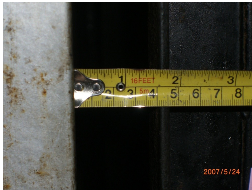
手拉門未緊閉，電氣連鎖裝置即可作用。
