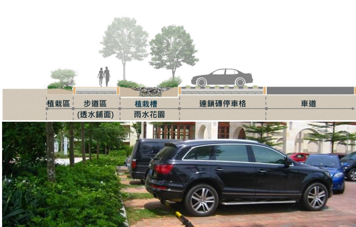
圖 1.6- 6 停車場美化建置剖面示意圖
