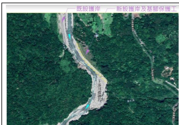
圖 1. 護岸預定地下游有一處淤積區域，建議石材來源由此處優先取用。
