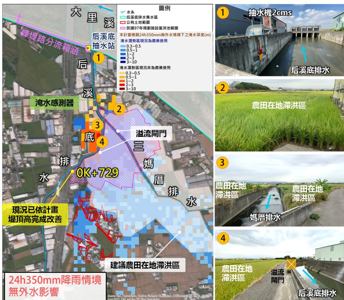
圖 6-12 后溪底排水逕流分擔方案初步構想
