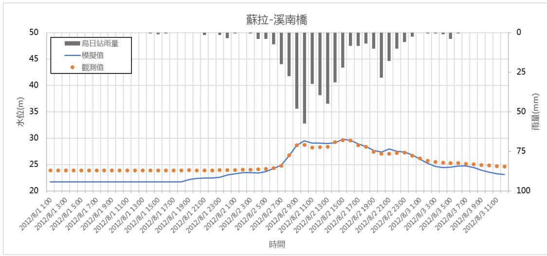
圖 3-14 蘇拉颱風-模擬水位與實測水位比較驗證圖(溪南橋)
