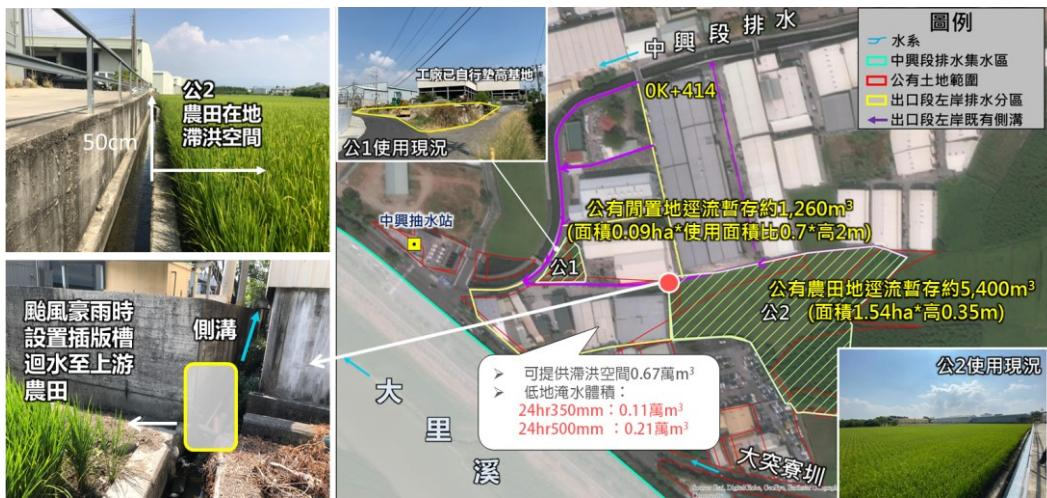
摘圖 3 中興段排水出口段短期逕流分擔方案初步構想
