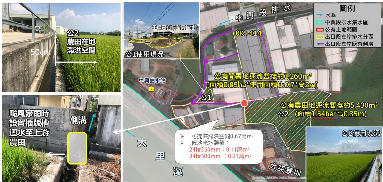
圖 6-7 中興段排水出口段短期逕流分擔方案初步構想
