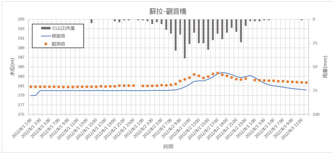
圖 3-17 蘇拉颱風事件-模擬水位與實測水位比較驗證圖(觀音橋)
