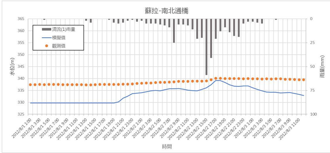
圖 3-18 蘇拉颱風事件-模擬水位與實測水位比較驗證圖(南北通橋)
