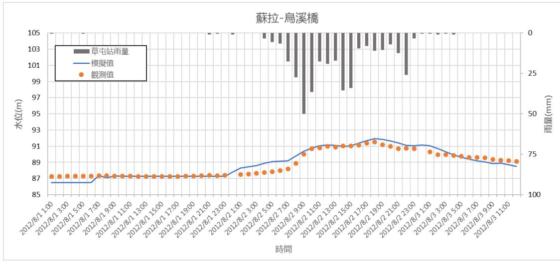
圖 3-15 蘇拉颱風-模擬水位與實測水位比較驗證圖(烏溪橋)
