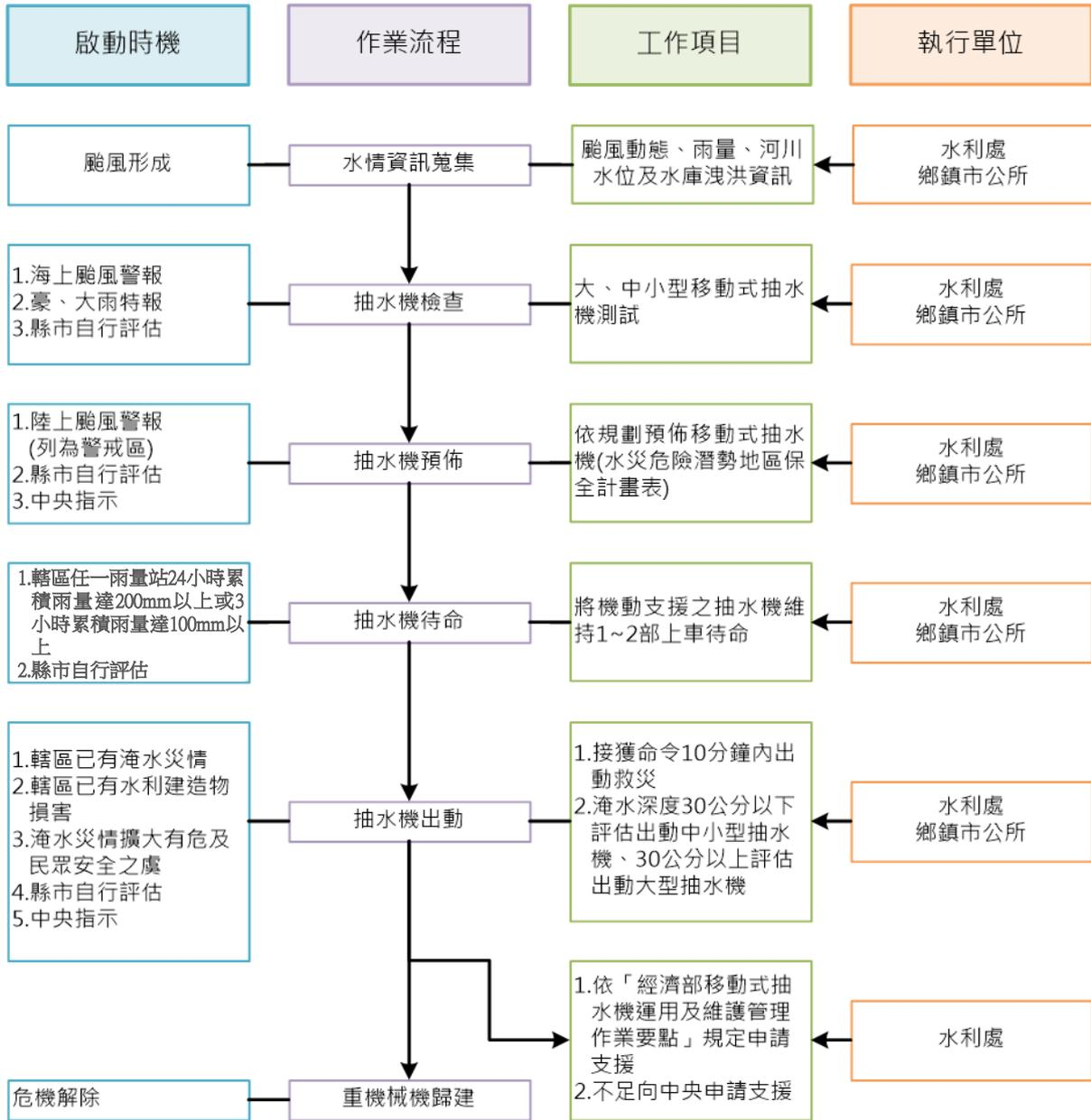
圖 3-3 移動式抽水機運用流程圖
