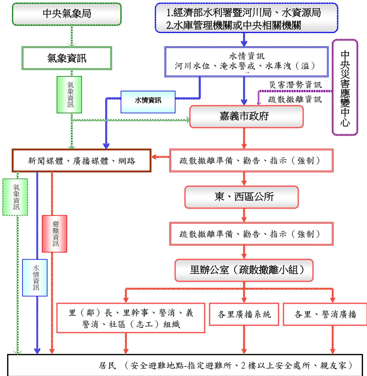
圖 3-5 水災疏散撤離資訊傳遞流程圖
