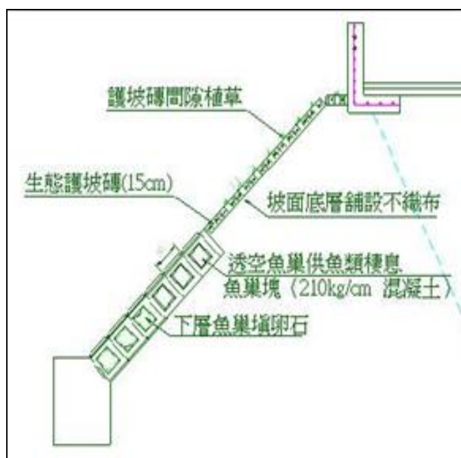
圖 6-19 生態景觀堤防構造示意圖
