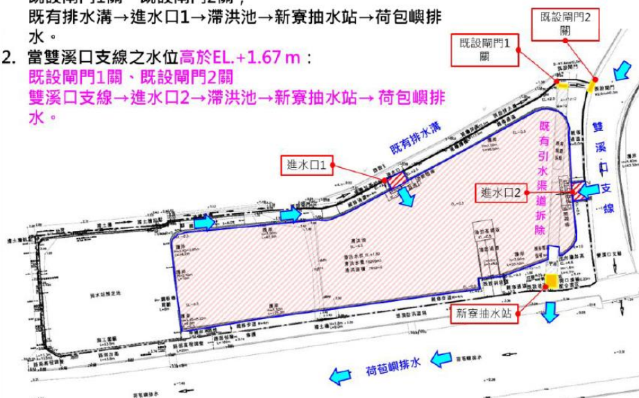
圖 2-19 民國 109 年雙溪口支線抽水站治理工程補充規劃工程布置圖
