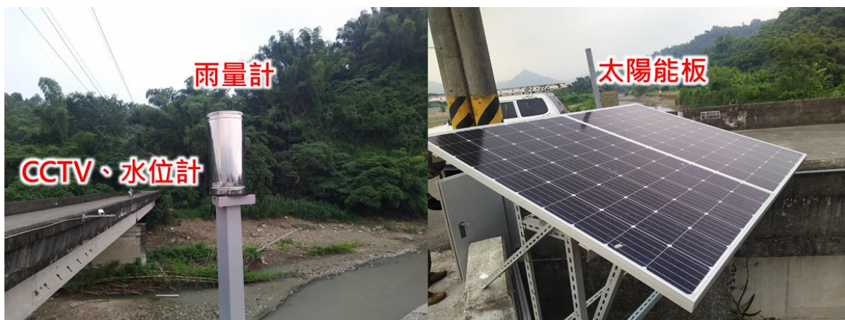
圖5-11 A點觀測站(過路窩橋)現場儀器佈置
