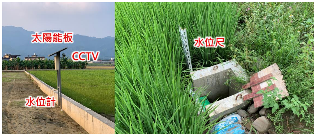
摘圖 22 B 點觀測站(水稻田區)現場儀器佈置
