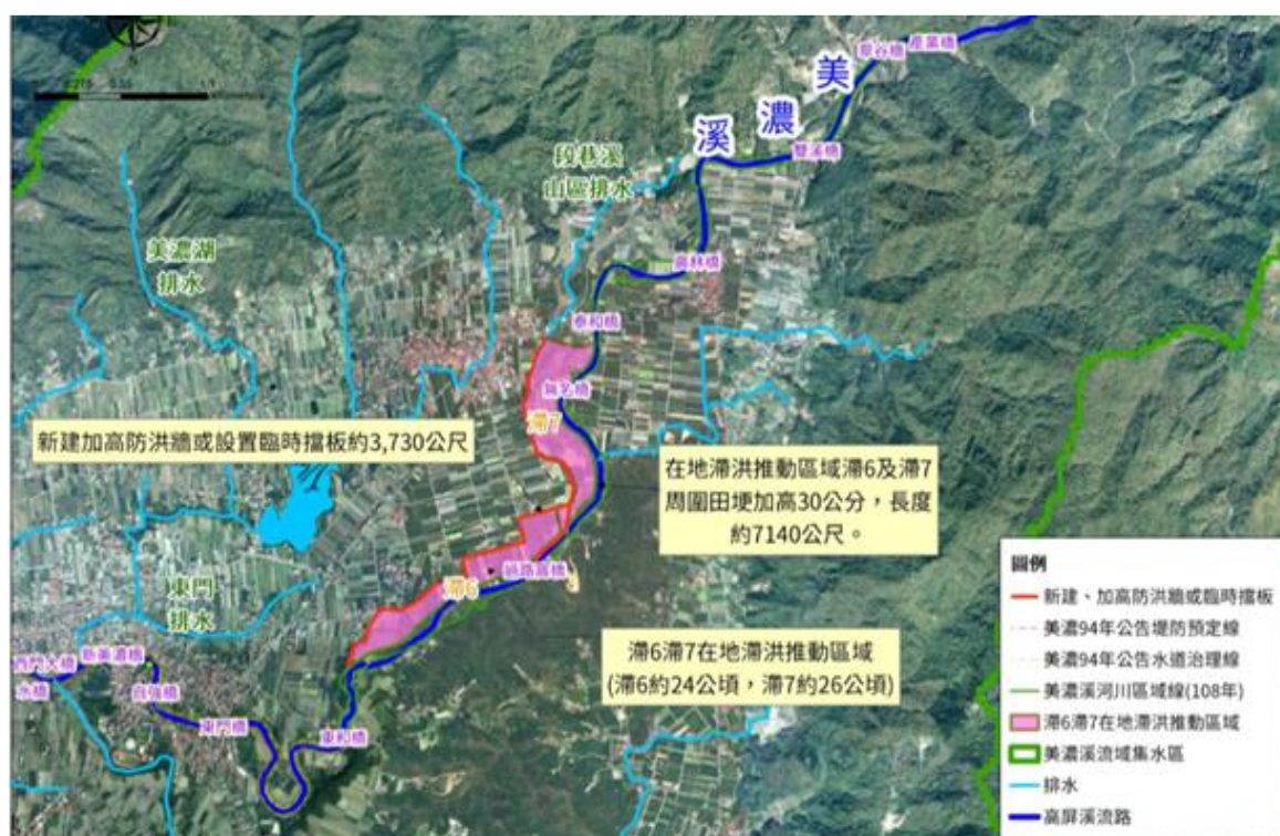
圖5-46 美濃溪上游段在地滯路堤方案布置圖
