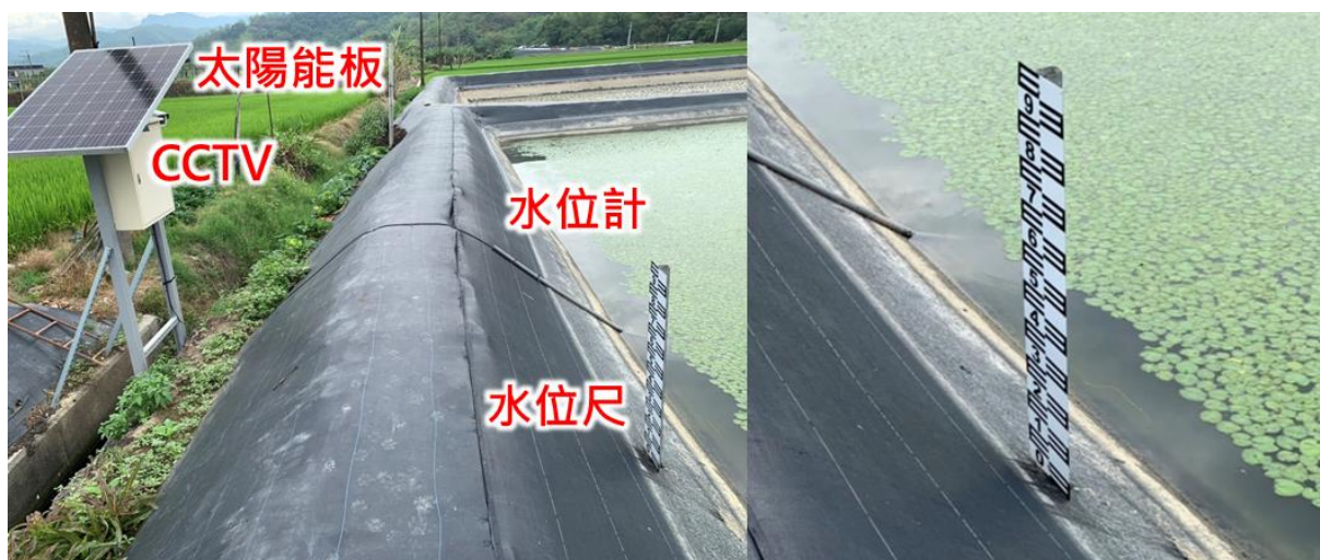
圖5-13 C點觀測站(野蓮池區)現場儀器佈置
