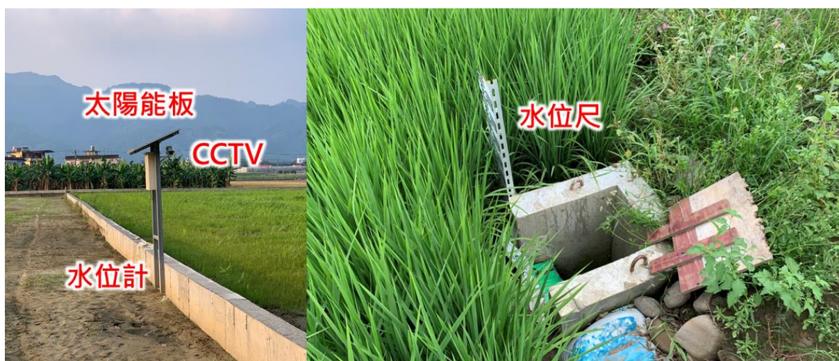
圖5-12 B點觀測站(水稻田區)現場儀器佈置
